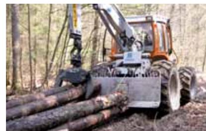
**System Aufnahme Rahmen (SAR) mit integrierter Wechselkonsole.** Schwere und weitreichende Arbeitsgeräte wie ein Kran benötigen zum einen den optimalen Aufbauraum und zum anderen ein Anbaukonzept zum leichten An- bzw. Abbau mit einem Tragrahmen der für die nötige Stabilität sorgt.
