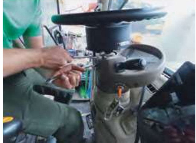
Der Lenkradmotor ist fest an der Lenksäule zu fixieren und darf kein Spiel haben.
