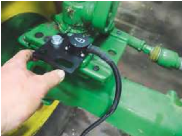
Der Lenkwinkelsensor wird angeklemt und justiert sich dann von selbst.
