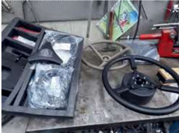
Das originale Lenkrad (braun) wurde ausgetauscht und durch das schwarze ersetzt.
