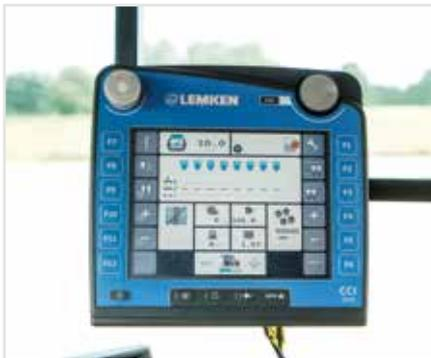
MegaSeed ist das neue ISOBUS-basierte Bedienkonzept im einheitlichen LEMKEN Design für die Einzelkornsämaschine Azurit 9.
