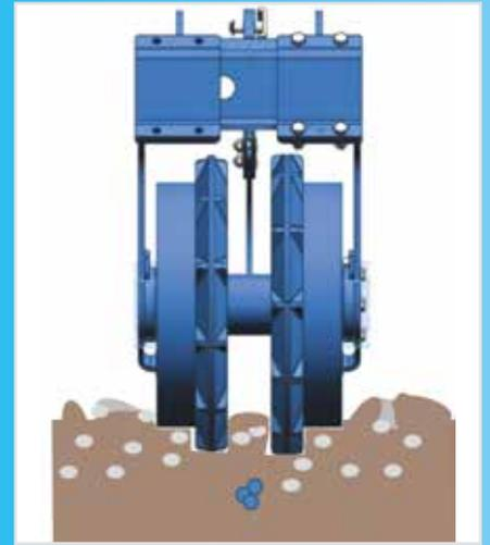
Das Trapezpackerwalzenelement verschließt das Düngerband und sorgt gleichzeitig für eine Rückverfestigung des Saathorizontes. So ist der kapillare Wasseraufstieg gewährleistet und sorgt somit für ein zügiges und gleichmäßiges Auflaufen der Pflanzen.
