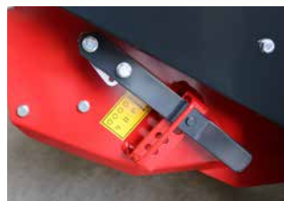
Mit dem Gegenrechen wird der Aufbereitungseffekt verstellt
