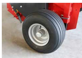
Standardbereifung – K 818XE 18 x 8.50 – 8", Ø 45 cm
