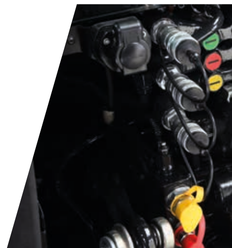
> Jusqu'à 3 distributeurs arrière avec régulateur de débit et retour libre.
