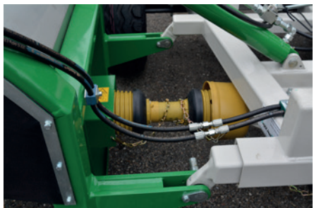
Direkter Antrieb. Getriebe auf Umsetzwelle.
