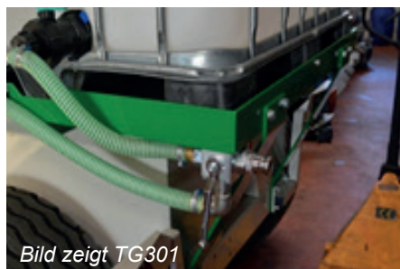
Externe Wasseransaugmöglichkeit für Fremdansaugung.
