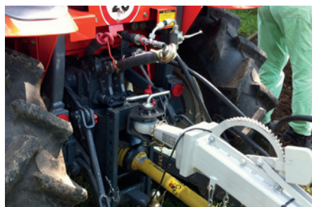
Schwimmstellung. Falls der Traktor über keine eigene verfügt.
