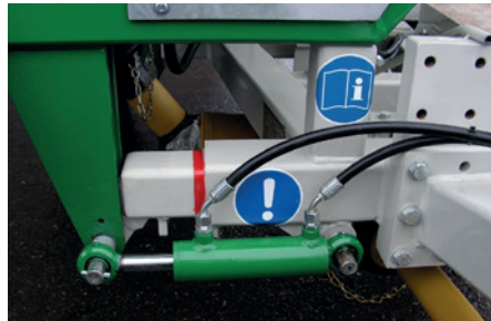
Hydraulische Seitenversatzung, damit die Miete da bleibt, wo sie hingehört.
