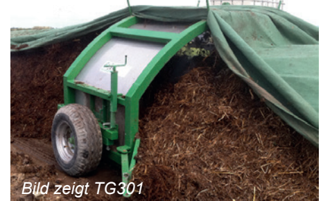
Das Vlies wird auf schmale Breite zusammengeführt, damit die Gase entweichen können. Die schwere Handarbeit entfällt.
