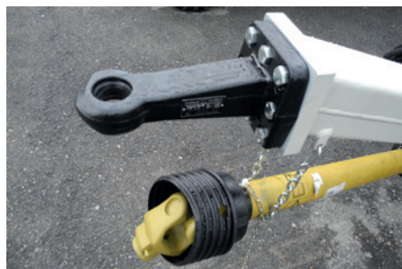
Standard-Anhängekupplung vorne: DIN-Zugöse
