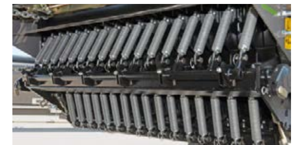
Genauso lässt sich auf Wunsch das Schneidwerk hydraulisch von Arbeits- in Servicestellung schwenken.
