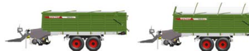
Der klappbare Dürrfutteraufbau kann von der Kabine aus ein- und ausgeklappt werden. Durchfahrten sind so kein Problem und für die Heuernte kann der Laderaum so schnell vergrößert werden.
