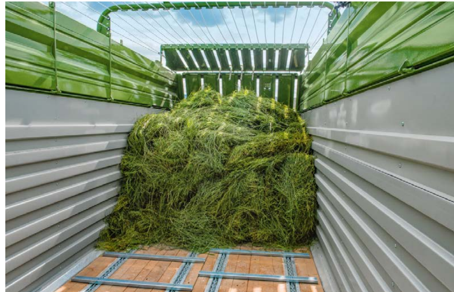
Mit der Zwei-Stufen-Ladeautomatik erfolgt die leichte Pressung über einen Tastrechen während die Mittlere über die Ladeklappe erfolgt.
