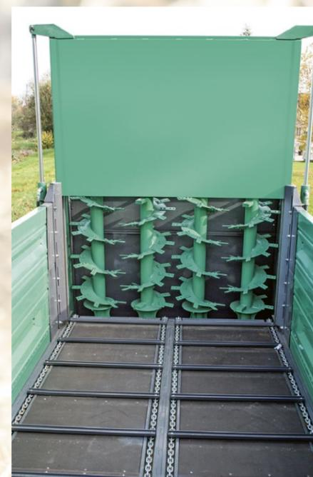
Kratzbodenleisten Hydraulischer Stauschieber
