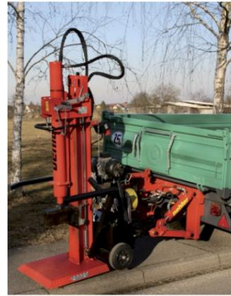
OL EDK 60 S mit Dreipunktbau und Zapfwellendurchtrieb mit Holzspalter OL 190
