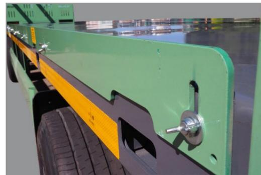
Verstellbare Sicherungsleiste für Großkistentransport
