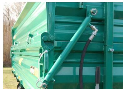
Hydraulisch verschließbare Bordwand
