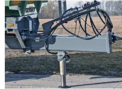
Hydraulischer Stützfuß, doppelwirkend
