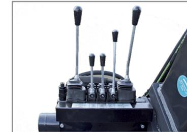
Kreuzhebelsteuerung 7-fach mechanisch
