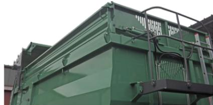
Hydraulisch abklappbarer Aufsatz
