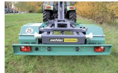
OL EHKL 80 Unterfahrerschutz mit Beleuchtungsanlage
