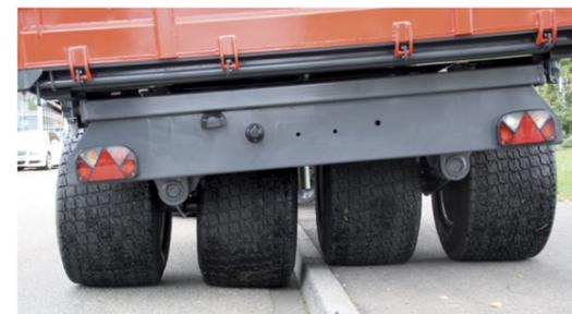
OL EDK 60 SG Höhenausgleich durch Pendelachse
