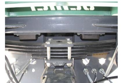
Gefederte Zugdeichsel bis max. 4t Stützlast
