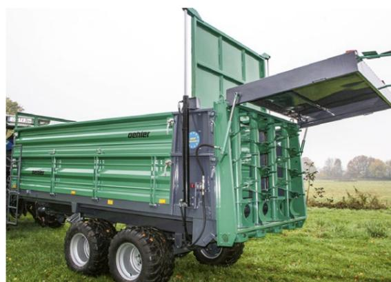
OL STT 80 mit Stauschieber + hydraulischem Streuschutz
