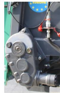
Getriebe + Danfoss-Ölmotor
