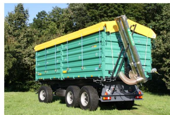
OL DDK 240 mit zusammengeklappter Kornschnecke
