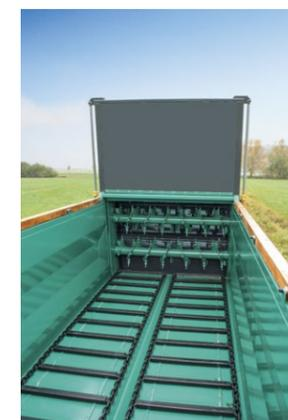
Kratzbodenleisten Hydraulischer Stauschieber
