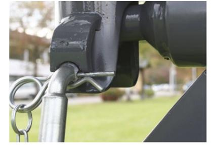
Kipplager mit Überkreuzstecksicherung
