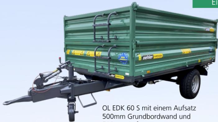
OL EDK 60 S mit einem Aufsatz 500mm Grundbordwand und 500mm Aufsatz
