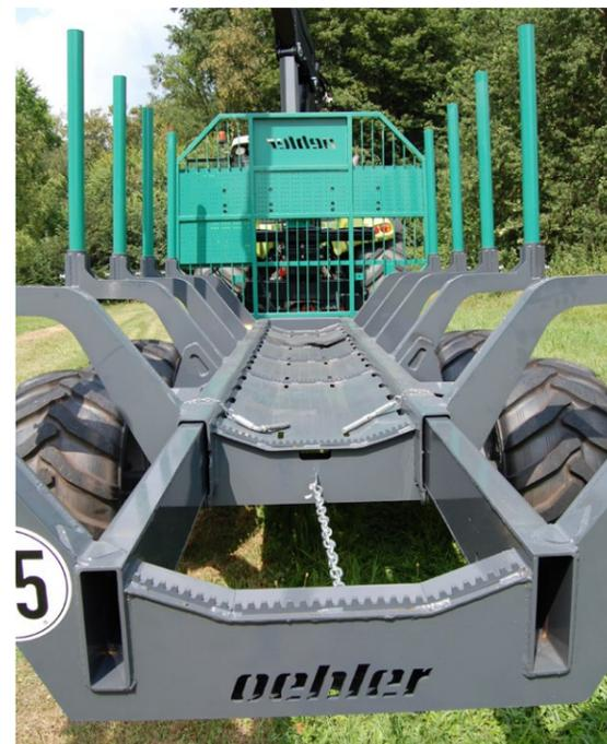
Stabiler und ausziehbarer Doppelrohrrahmen
