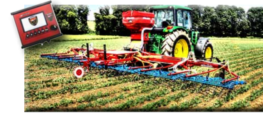
„Original“ Striegel, 9 m Arbeitsbreite, mit pneum. Sägerät „Air 16“ mit Antrieb über Sensorsporenrad oder Radar mit Bordcomputer - Bedienung von der Traktorkabine, 400 Liter Fassungsvermögen, 16 Säuslässe, geeignet für Arbeitsbreiten bis 12 m. Auch zum nachträglichen Aufbau für Neu- und Untersaat.
