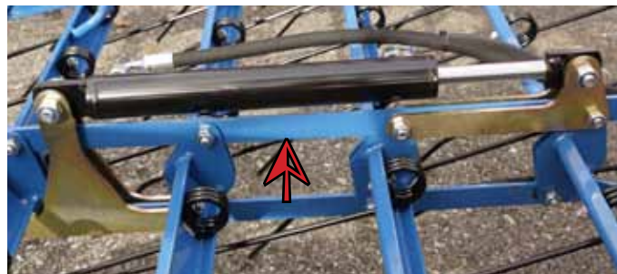
Hydraulikzylinder für hydraulische Zinkenverstellung zum Einstellen der Zinkenaggressivität von der Traktorkabine
