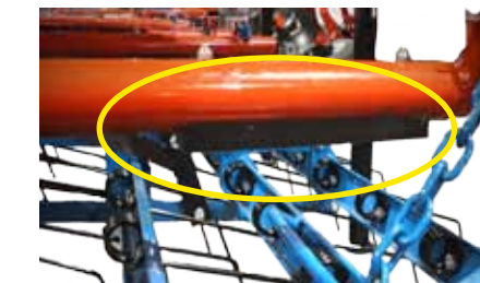
Verschleißteile aus verschleißfestem Kunststoff
