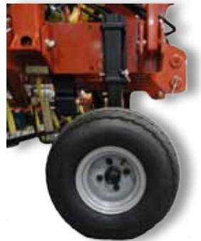
Höhenverstellbares Stützrad mit eingeschraubten Radnaben und Schrägrollenlager.
