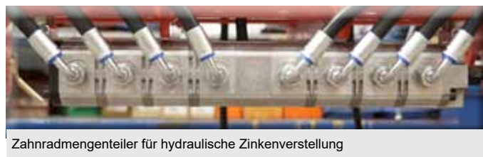
Zahnradmengenteiler für hydraulische Zinkenverstellung
