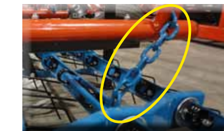
Jedes Striegelgedräger ist einzeln an Ketten aufgehängt um die optimale Boden Anpassung zu gewährleisten
