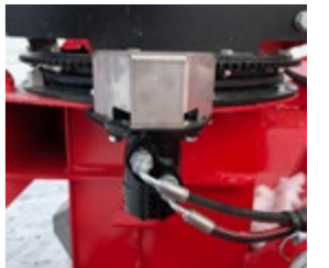
Neuer, größerer 50-ccm-Hydraulikmotor für Schwenkfunktion des Auswurfs
