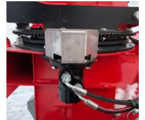
Neuer, größerer 50-ccm-Hydraulikmotor für Schwenkfunktion des Auswurfs.
