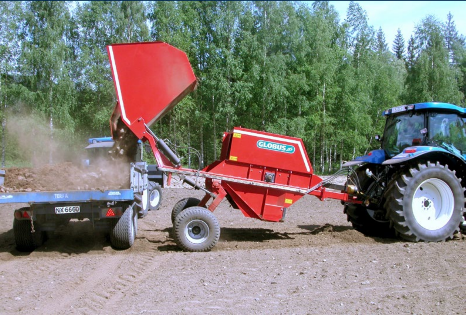
Hydraulisches Anheben der Radachse ergibt eine Kipphöhe von 2 m.
