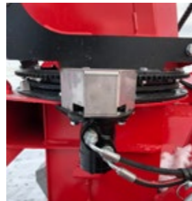
Neuer, größerer 50-ccm-Hydraulikmotor für Schwenkfunktion des Auswurfs.
