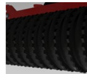
Robuste 50 cm Ringe ergeben eine gute Verdichtung.
