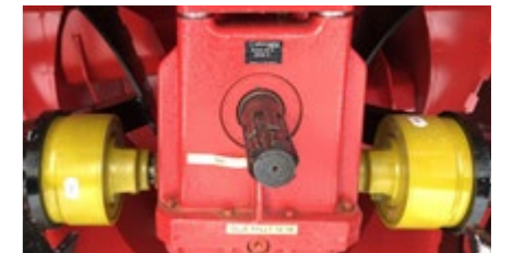
Großes, robustes Getriebe und Überlastschutz an der Schnecke.
