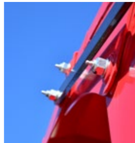
Schmiernippel an allen Bolzen des Abweisers.
