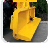
Le tablier articulé hydrauliquement, à cause du centre de gravité plus bas, permet la manipulation plus facile du bois et l'empilage plus facile des grumes.
