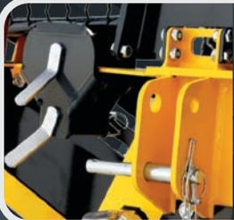
Montage simple et rapide du treuil sur le tracteur. Il est possible de fixer, après utilisation, l'attelage sur le cadre du treuil.
