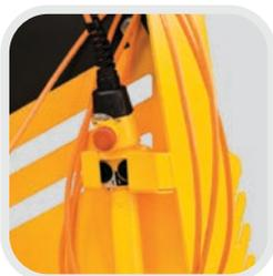
Console de commande avec passage automatique de déconnexion à l'impulsion vers une déconnexion fixe.
