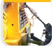
Les treuils à trois points 65HF et 65HFpro peut se connecter à l'avant et à l'arrière. Les modèles possèdent dans son équipement de série un appareil de déroulement avec un frein.
