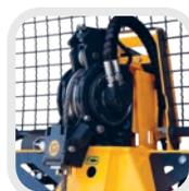
AUTO STOP (interrupteur de limite) désactive automatiquement la fonction d'enroulement du câble de traction sur le tambour. Cette fonction prévient : les dommages mécaniques de l'appareil de déroulement, le blocage et les dommages au câble d'acier.
