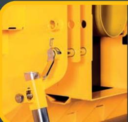
Deux hauteurs différentes d'attelage au tracteur avec une protection fiable contre la chute des axes de connexion (fixation du pied de soutien).
