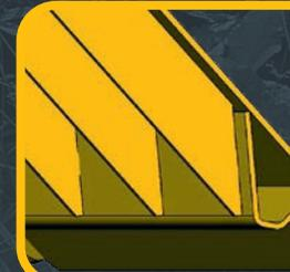
Tablier de treuil robuste, renforcé en dessous avec une plaque d'acier résistante à l'usure.
