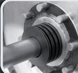
Les ressorts en spirale assurent un enclenchement et un désenclenchement précis de l'embrayage (85MR, 55H/Hpro).
