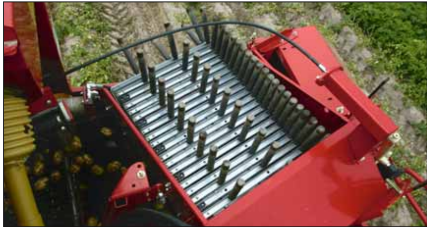
Die Geschwindigkeit des Fingerbandes ist stufenlos hydraulisch verstellbar.
