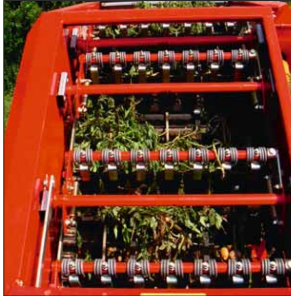
Optimale Produktschonung: Grobkrautband mit weichen PU-Mitnehmern (Abstände jeweils 210 mm, 280 mm)
