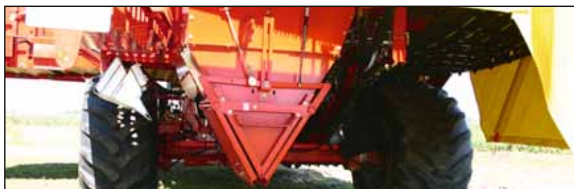
Optionaler Sammelbehälter unter der Walzensvorreinigung
