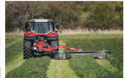
Mähbalken mit flachem Profil und Stirnradantrieb
