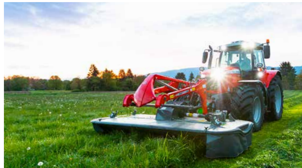
Mähbalken mit flachem Profil und Stirnradantrieb
