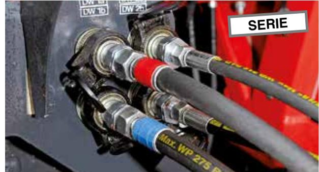
Steht nur 1 EW mit Rücklauf oder 1 DW Steuergerät zur Verfügung, so werden die einzelnen Funktionen über den **Reihenschalter RSH** bedient.
