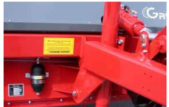
Die optional erhältliche Deichselfederung bringt spürbaren Fahrkomfort. Deutlich reduzierte Fahrzeugschwingungen auf den Traktor.
