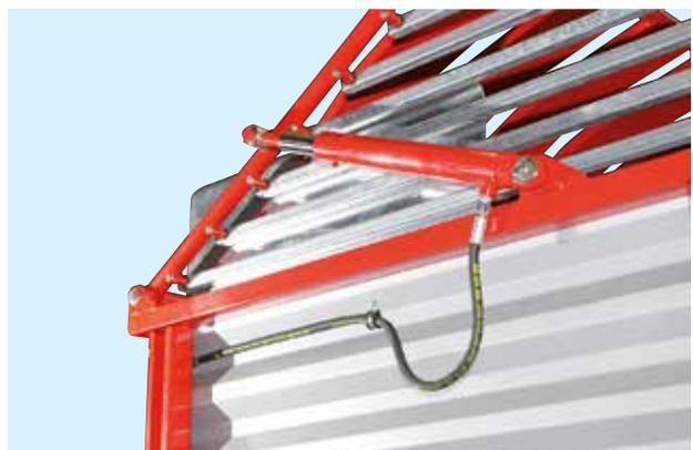
Mit dem **hydraulischen Scherengitteraufbau** (Wunschausrüstung, bei PA 450 H Serie) kann die Gesamthöhe bequem abgesenkt werden.
