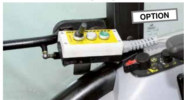
Elektronische **Komfortsteuerung pro Control**. Load sensing fähig. Jede Funktion wird bequem über Folientastatur geschaltet. Die Infos und Symbole am Display sind selbsterklärend. Die Kratzbodengeschwindigkeit ist stufenlos regelbar.
