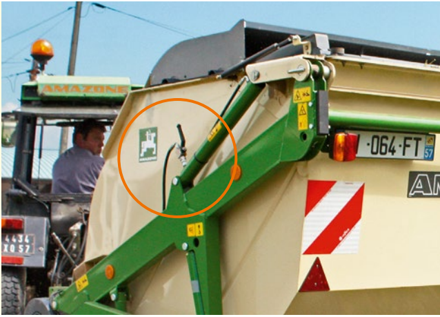
Sécurité sur le vérin hydraulique pour les Tondobalais proposant la vidange en hauteur
