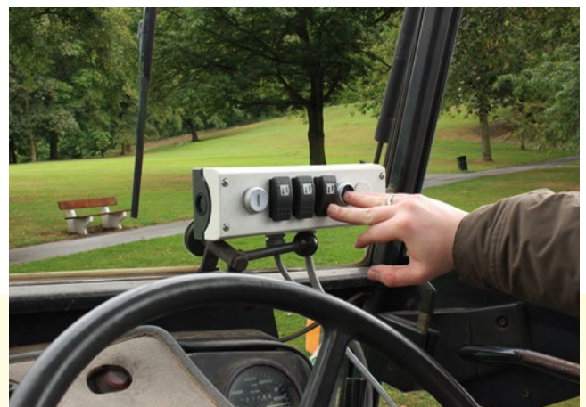
La commande électrohydraulique permet un pilotage aisé de toutes les fonctions hydrauliques sur les machines de types GHD, GHS et GHS Drive (option)
