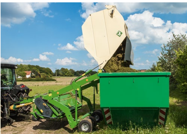
Avec 2,30 m, la vidange de la benne est possible dans des containers plus hauts ou des remorques plus grandes
