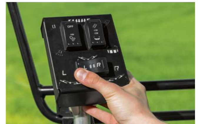
Für das DISCO 1100 TREND gibt es eine praktische Bedieneinheit für den Einzelaushub, die Klappung in Transportstellung und optional das Ein- und Ausschalten der Arbeitsscheinwerfer.
