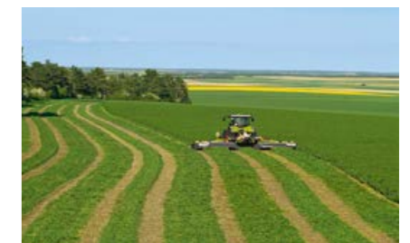
Optimales Arbeitsergebnis auch im Kurvenbereich durch maximale Überlappung (bis 60 cm).
