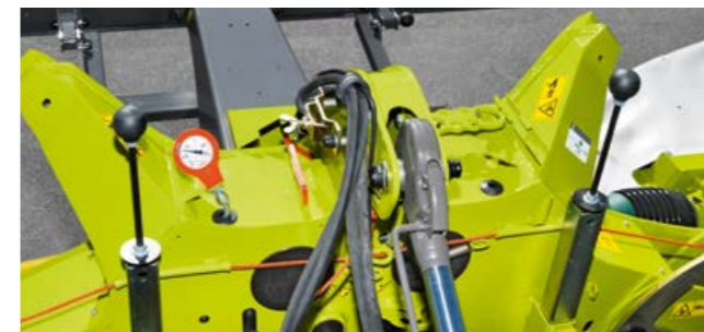
Ein Manometer zur einfachen Einstellung des Auflagedrucks für beide Mäheinheiten.
