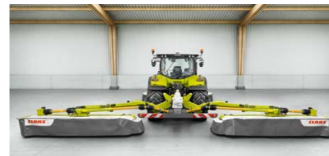
Zwei hydraulisch steuerbare Teleskopausleger mit stufenloser Einstellung für optimale Überlappung beim DISCO 1100 TREND.
