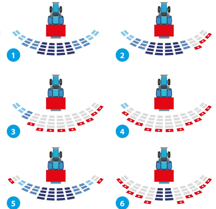
**1** **ECONOV** mit **ISOBUS** schaltet 12 Teilbreiten unabhängig von der Arbeitsbreite (hier bei voller Arbeitsbreite mit 12 geöffneten Teilbreiten).
