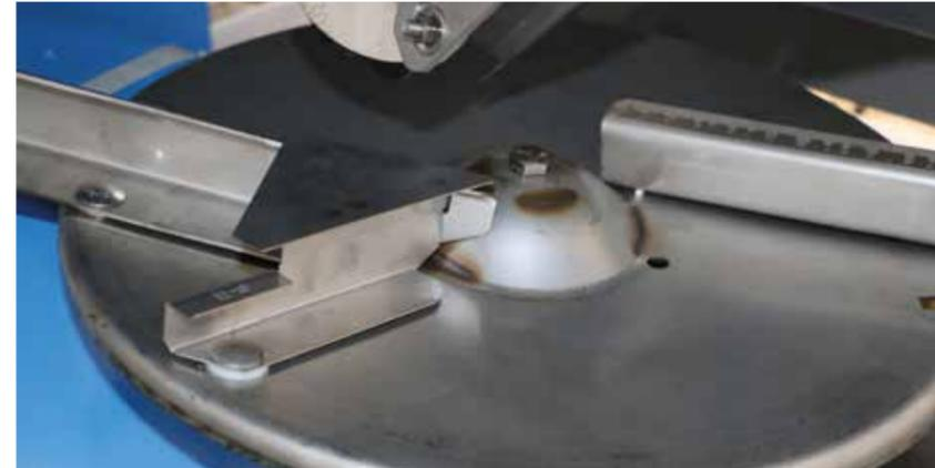
Die **ECOBORD** Wurfschaufeln werden beim Spica 8 eingesetzt, um den Dünger nicht über die Feldgrenze hinaus zu streuen. Sie lassen sich schnell und einfach – ganz ohne Werkzeug – an den Streuscheiben montieren.
