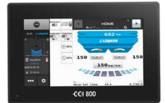
Das neue **CCI-800 ISOBUS** Terminal bietet den gleichen Funktionsumfang wie das CCI 1200-Terminal, jedoch kompakter verpackt.
