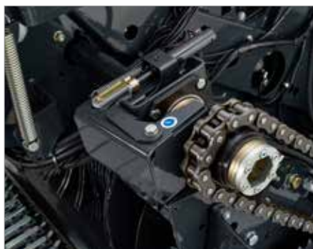
4. Débrayage hydraulique du rotor en cabine
