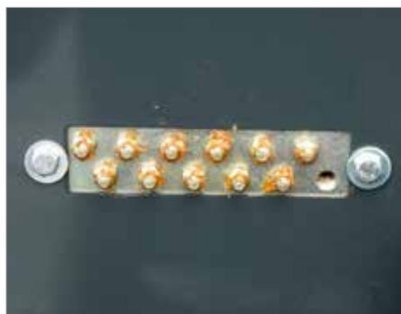
6. Réservoirs de graisse centralisés pour les roulements
