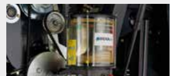
Système de graissage automatique pour les roulements (conteneur de 4 kg)
