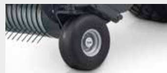
Roues de jauge de pick-up pivotantes et semi-pneumatiques
