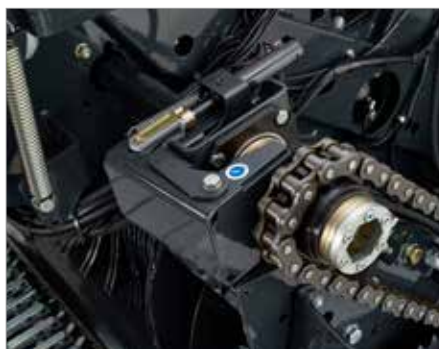
4. Débrayage hydraulique du rotor en cabine
