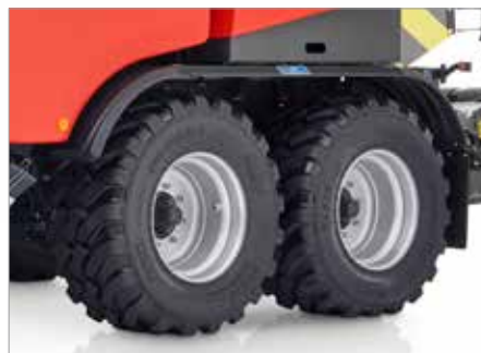
9. Essieu tandem avec pneumatiques 500/60R22.5
