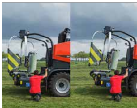
8. VBP 7190 : possibilité d'élever le mat des satellites pour passer des balles > 1,60 m sur la table d'enrubannage
