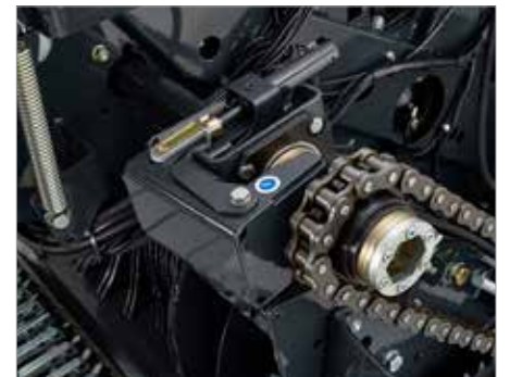
4. Débrayage hydraulique du rotor de série
