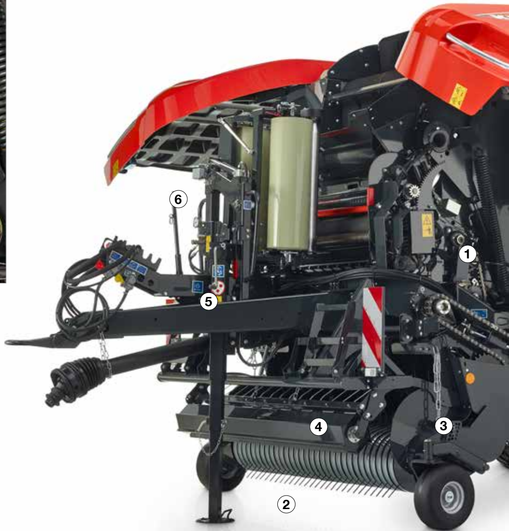
1. Double entraînement de la nappe de courroies pour travailler dans toutes les conditions
