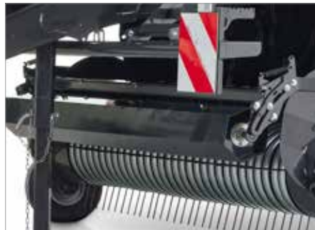
5. Rouleau tasse andain de grand diamètre (217 mm) avec peignes régulateurs actifs pour garantir une compaction optimale et un flux régulier au rotor
