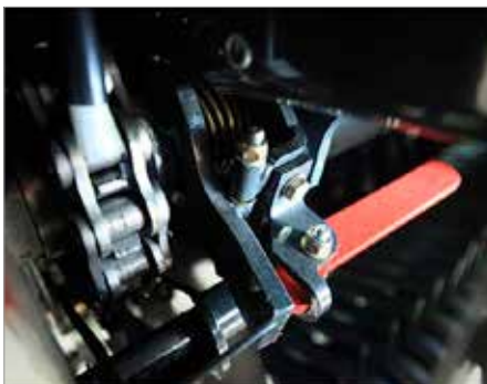
4. Débrayage mécanique du rotor
