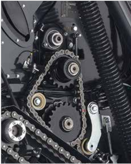
1. Double entraînement de la nappe de courroies pour travailler dans toutes les conditions
