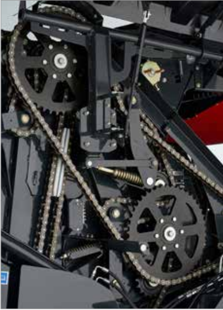
1. Transmission robuste avec chaînes IWIS de qualité supérieure
