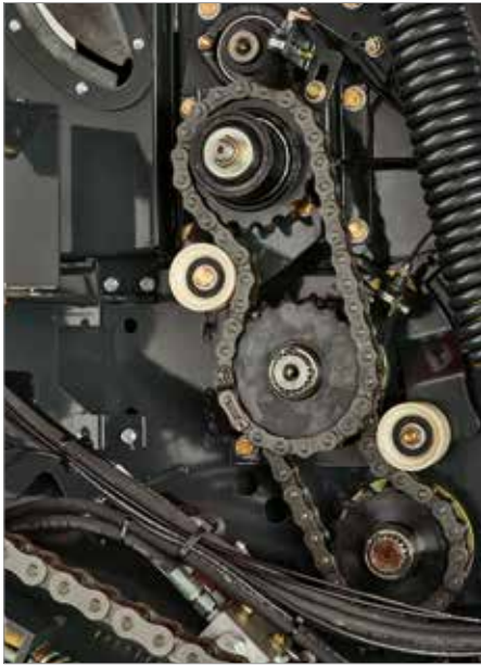
1. Double entraînement de la nappe de courroies pour travailler dans toutes les conditions
