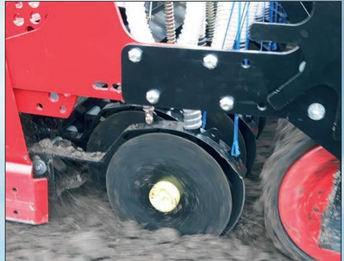
Mit dem **Federpacker** werden je zwei Schare pro Packerrad genau in der Tiefe geführt. 8 von 12 Rädern können 4 cm einfedern und 8 cm ausstossen. Mit den restlichen 4 Rädern wird die Kreiselegge in der Bearbeitungstiefe geführt.
