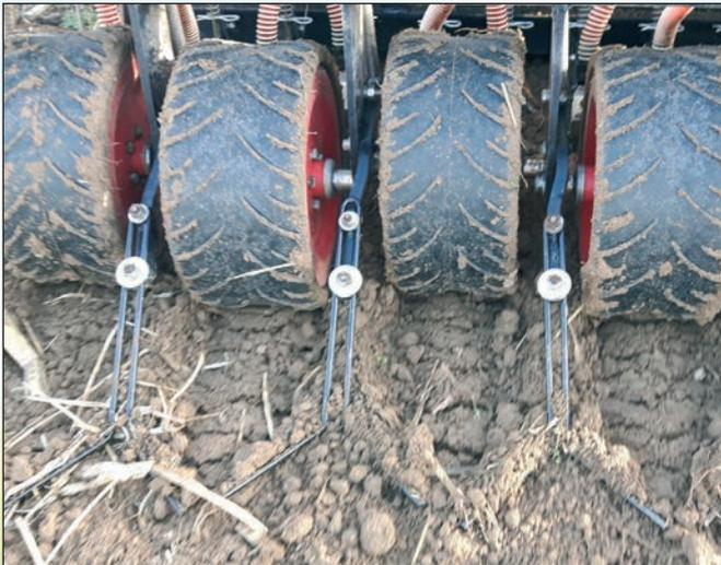
Der bearbeitete Boden wird zusammen mit den Ernterückständen über die erzeugte Kraft der Kreismesser unter dem Staubalken und somit auch durch die dahinterliegenden Scharmesser **hindurchgepresst**.
