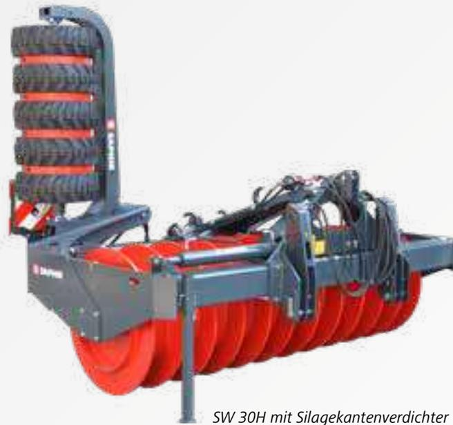
SW 30H mit Silagekantenverdichter und Beleuchtung
