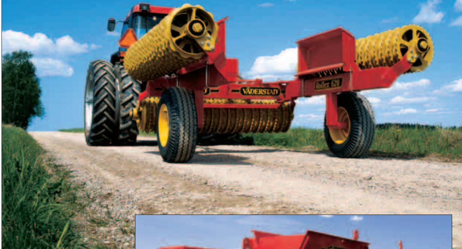
Der Wechsel zwischen Transportposition und Arbeitsposition ist einfach und kann vorgenommen werden, ohne dass der Fahrer den Traktor verlassen muss. Die Transportsperren an den Walzen werden während des Einklappens und Ausklappens automatisch verriegelt und gelöst.
