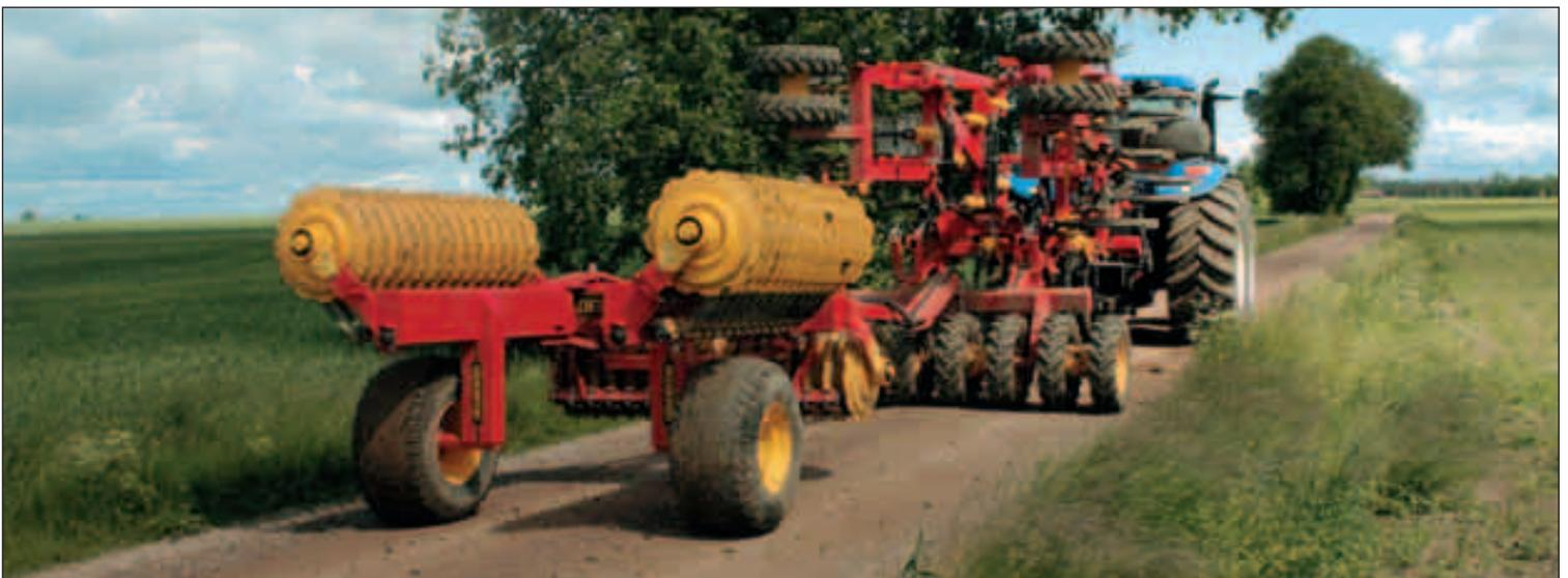
Durch die Anbindung mit der langen Zugstange folgt die Rexius Walze problemlos auch anderen Bodenbearbeitungsgeräten.
