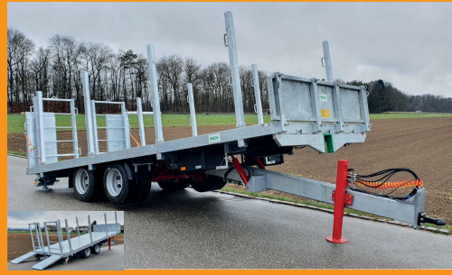
TA-S 160 / 190 / 210 - 16 / 19 / 21 To. 650 / 700 / 750 / 820 x 250 / 255 cm hydr. Heckabsenkung / basculante
