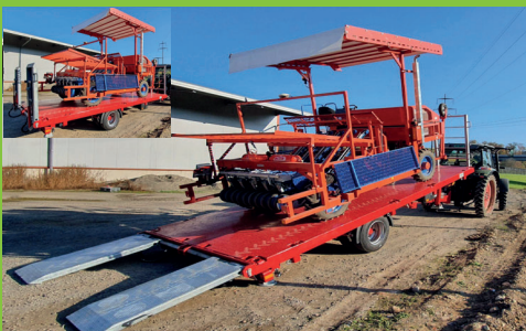
EA-S 80 / 100 / 120 - 8 / 10 / 12 To. 500 / 550 / 600 x 250 / 255 cm hydr. Heckabsenkung / basculante
