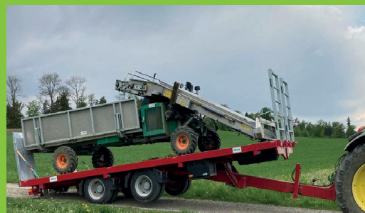
TA-S 160 / 190 / 210 - 16 / 19 / 21 To. 650 / 700 / 750 / 820 x 250 / 255 cm hydr. Heckabsenkung / basculante
