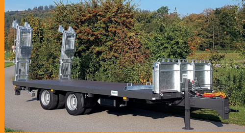
TA-S 160 / 190 / 210 - 16 / 19 / 21 To. 650 / 700 / 750 / 820 x 250 / 255 cm hydr. Heckabsenkung / basculante
