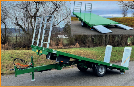
EA-S 80 / 100 / 120 - 8 / 10 / 12 To. 500 / 550 / 600 x 250 / 255 cm hydr. Heckabsenkung / basculante
