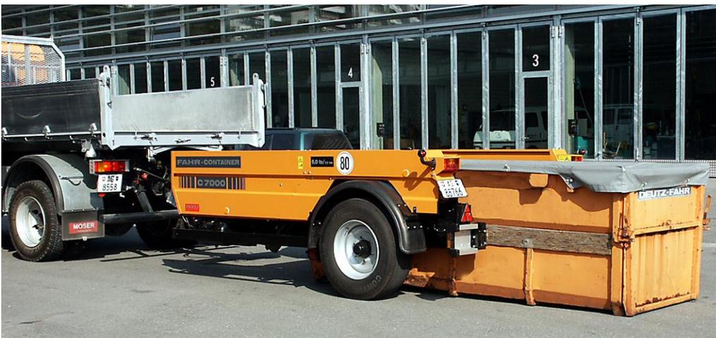
Durch Anheben der an die Hydraulik angeschlossenen Druckzylinder kuppeln sich die Hubarme selbsttätig mit dem Container und bringen ihn in die mechanisch verriegelte Transportstellung. Die gesamte Bedienung wird vom Fahrer der Zugmaschine vorgenommen.
