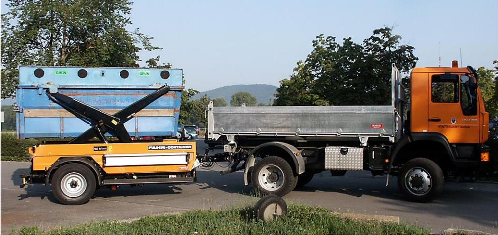
Dieses denkbar einfache System hat sich im Laufe der Jahre bei Bauhöfen, Strassenmeistereien und in der Abfallwirtschaft durchgesetzt. Mit dem offenen Heck des Fahrgestells fährt man rückwärts an den Container heran. Selbst in unebenem Gelände ist das Einfahren durch seitliche Führungs- und Laufrollen ohne Schwierigkeiten durchzuführen.
