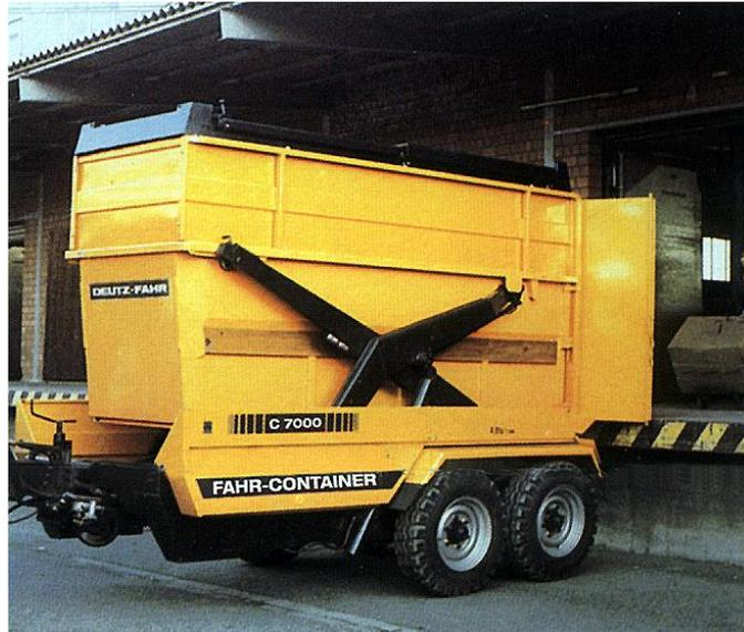
Der Fahrer bestimmt durch das senkrechte Absenken die exakte Stellung des Containers vor dem Absetzen. Lästiges Nachrücken oder Wegziehen des Behälters entfällt.
