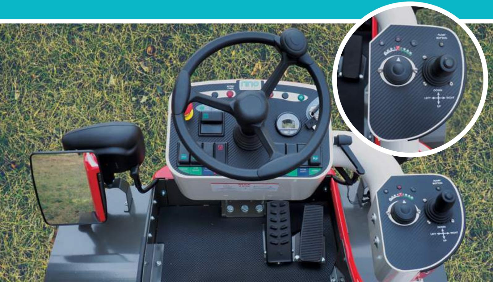
Die Bedienungs-, Informations- und Anwendungsschaltungen von **RINO®** basieren sich auf einem essentiellen und funktionalen Design. Die Hauptdaten werden auf dem Display angezeigt, mit der Möglichkeit, die benötigten Informationen auszuwählen. Die Geschwindigkeitssteuerung ist durch den
