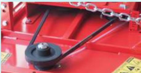
Das neue Riemenantriebssystem macht unsere Aufsitzmäher noch zuverlässiger. Keine verschlungenen Riemen mehr und weniger Verschleiß durch die drastisch reduzierte Riemenspannung, die auch extremsten Belastungen standhält.
