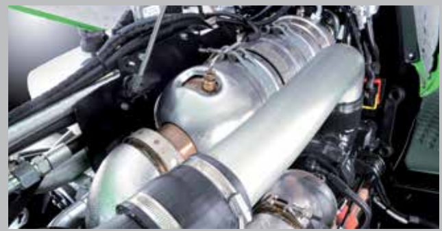
... DOC (Diesel Oxidations Catalyst) Katalysator sorgen für niedrigste Emissionswerte.
