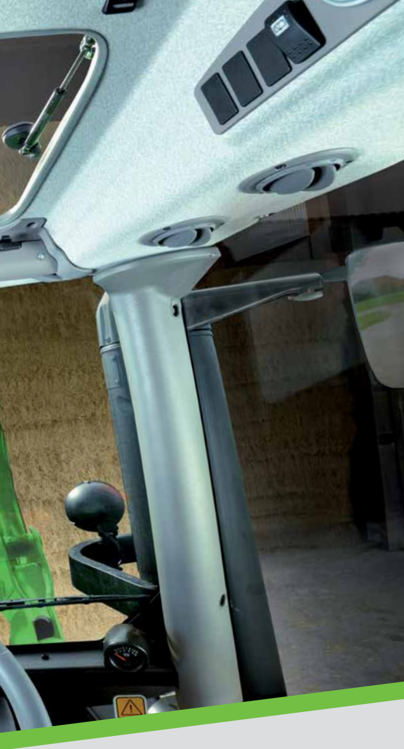
Frontlader-Joystick mit Powershift Knöpfen. Stop&Go und SDD Schnelllenksystem und alle...
