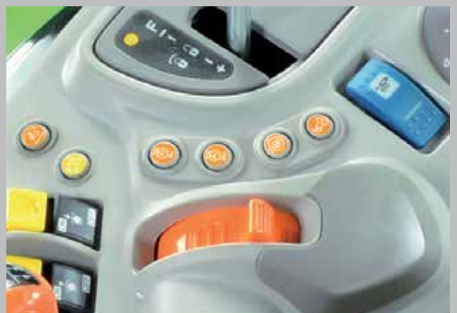
Neu: Zwei Motordrehzahlenspeicher. Effizienz für Routinearbeiten vorprogrammiert.
