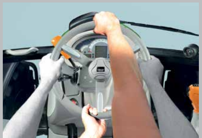
Das SDD Schnelllenksystem. Halbe Lenkraddrehung, doppelter Lenkeinschlag.
