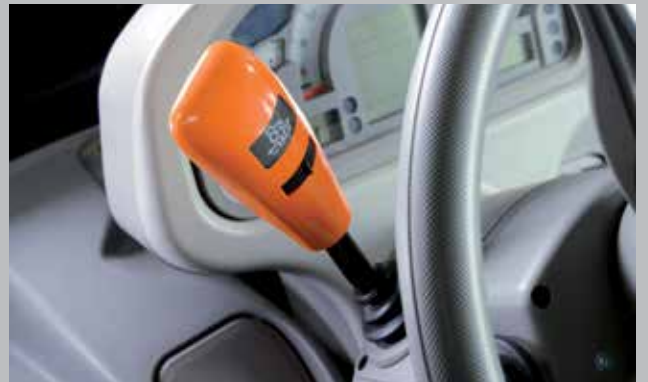
Powershuttle serienmäßig. Elektrohydraulische Wendeschaltung in 5 Stufen einstellbar.
