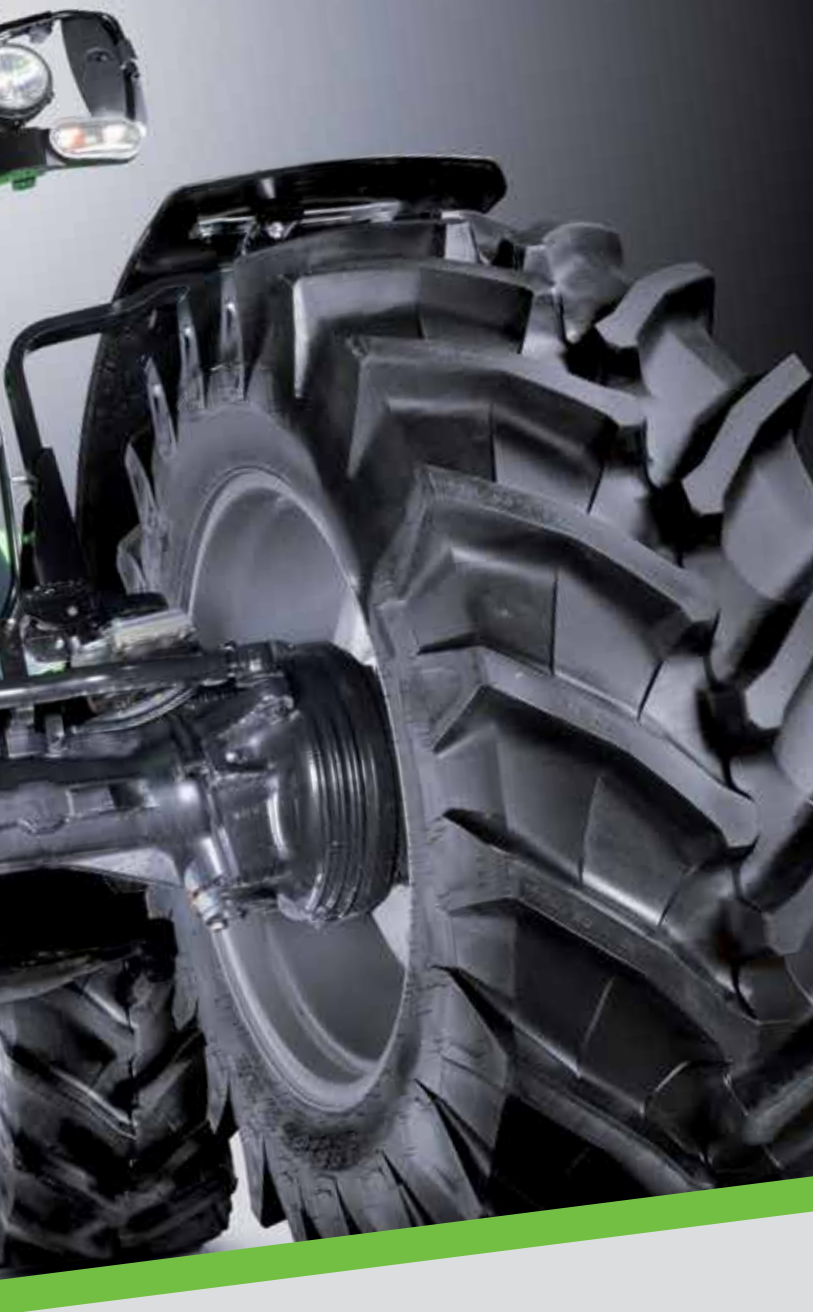
Einzigartiges Sicherheitskonzept von DEUTZ-FAHR. Separate im Ölbad gekühlte Scheibenbremsen an den Vorderrädern.
