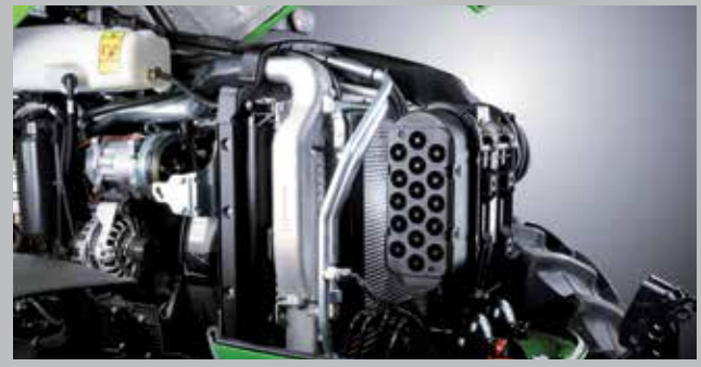
... das leicht zu reinigende Kühlsystem mit optionalem Viscolüfter.
