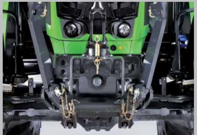
Frontanbauräum. 2100 kg Hubkraft und 1000er Zapfwelle.
