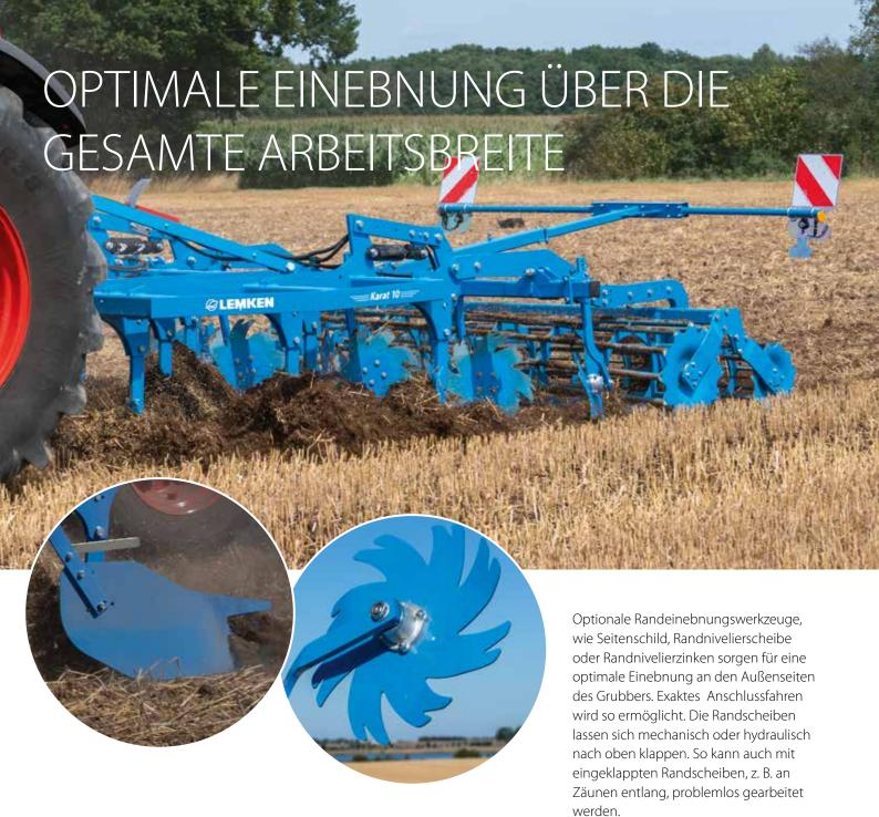
Hinter dem Zinkenfeld sorgen zentral einstellbare Nivellierelemente für eine gleichmäßige Einebnung.
