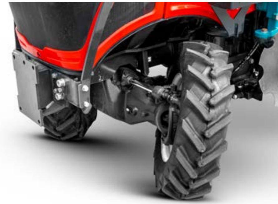
Die spezielle Form des vorderen Halfahrgestells ermöglicht es, dass die Räder unter den Motorblock passen, was **einen Lenkeinschlag von bis zu 55°** selbst bei minimaler Breite und **10° Schwingung der Vorderachse** ermöglicht. Der maximale Platzbedarf der Vorderräder entspricht dem vordersten Punkt der Motorhaube. Dadurch hat der Bediener auch beim Lenken immer einen genauen Überblick über die Gesamtabmessungen des Fahrzeugs.
