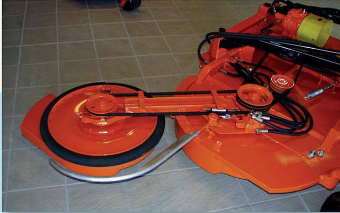
Um das Risiko einer Beschädigung junger Bäume zu verhindern und der Arbeit an Hängen möglich zu machen, kann die Schwenkscheibe mit einer hydraulischen Vortaster ausgestattet werden.
