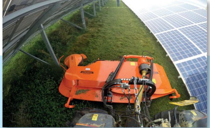
Die sehr große Seitenverstellung und die schwenkbare Scheibe machen den RF zu einem weltweit beliebten Mulcher für die Wartung unter und um Sonnenkollektoren und Zäunen.
