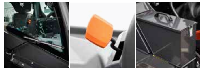
Wisch-/Waschanlage Seitenfenster | VNR-Hebel | Werkzeugkasten
