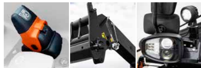
Handgas und Flex-Antrieb | Hydraulische Verriegelung Anbaugerät mit spezieller Zusatzhydraulikleitung | LED-Straßenpaket: • Fahrcheinwerfer • Rundum-Kennleuchte • Rückfahrleuchte
