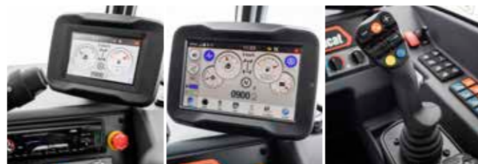
5-Zoll-Standarddisplay mit Bluetooth-Radio, Mikrofon und Lautsprecher | 7-Zoll-Touch-Display (integriertes Bluetooth-Radio mit Mikrofon und Job Manager) | Smart-Joystick
