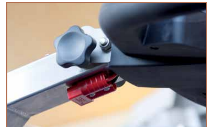
Batterieladestecker geschützt angebracht
