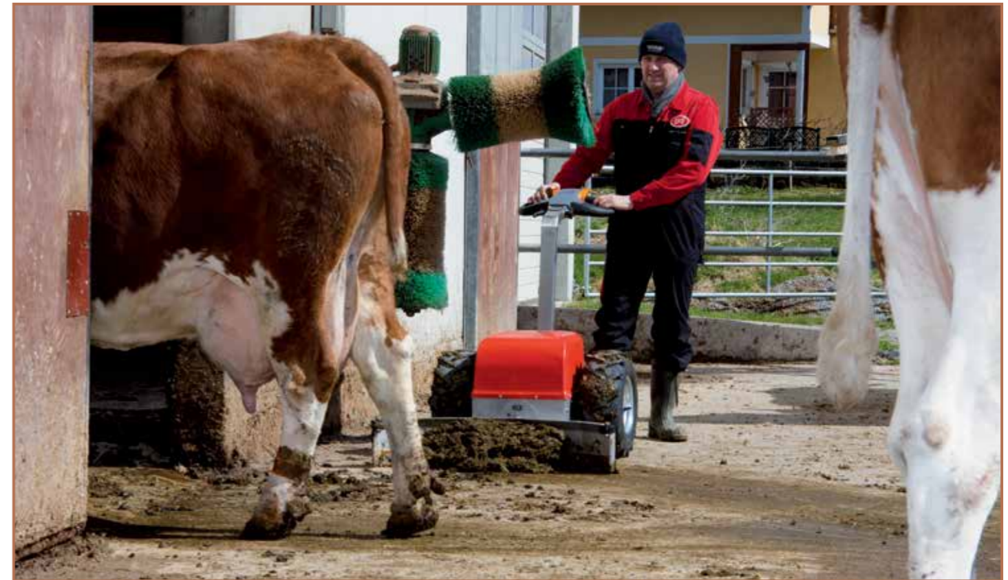
Kardanisch angebauter Schieber für optimale Bodenadaptation
