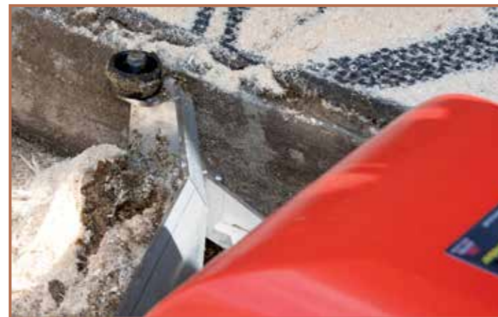
Seitliche Anlaufrollen am Schieber verbaut
