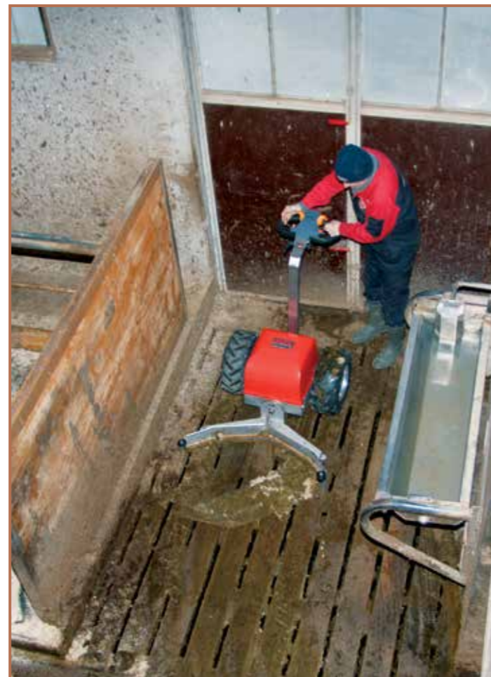
Serienmäßige Körperschutztafel für enge Bereiche
