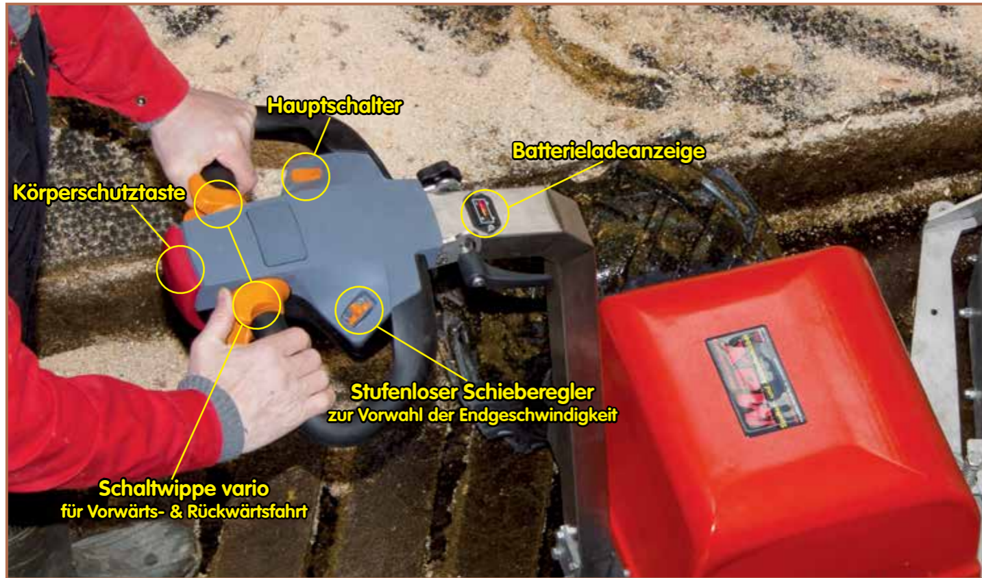
Ergonomisch geformter Deichselkopf für eine entspannte Bedienung
