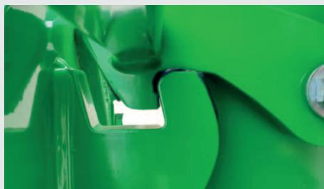
Système breveté de connexion automatique de liaison/déliaison. Élimine le travail fatigant de Tirer sur la corde pour détacher la machine
