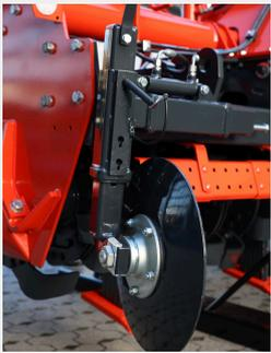
Die verstärkten Zuführscheiben verhindern eine Dammbildung und die Ansammlung von Ernterückständen an den Seitenblechen. In Höhe und Breite verstellbar, lassen sie sich jederzeit mühelos an die jeweilige Einsatzsituation anpassen. Die in Fahrtrichtung rechte Zuführscheibe kann hydraulisch eingefahren werden, um ein Überstehen bei Strassenfahrt zu vermeiden.
