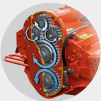
Alle Zahnräder des Getriebes sind beidseitig mit Kegelrollenlagern gelagert und mit einem sehr robusten Zahnradprofil ausgeführt. Der doppelte Antrieb der Mulchfräse, ähnlich einem Planetengetriebe, sorgt für eine reibungslose Übertragung des Drehmoments. Die Rotorlager sind mit speziellen, hochdichten Metallflachdichtungen ausgestattet. Sie sind extrem leistungsfähig und schützen die Lager vor eindringendem Schmutz.
