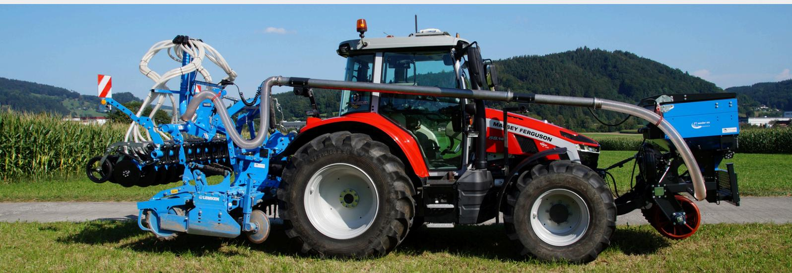
Die über den Oberlenker zurückbauende Form unserer Tanks ermöglicht geringen Überhang nach vorne und maximales Volumen bei geringer Bauhöhe. Der FT 650 und FT 1000 können durch einen passenden Aufsatz für mehr Volumen erweitert werden.
