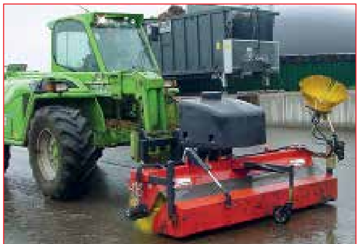
KM 570 TL mit hydraulischer Wannenhöhenverstellung und 3. Stützrad
