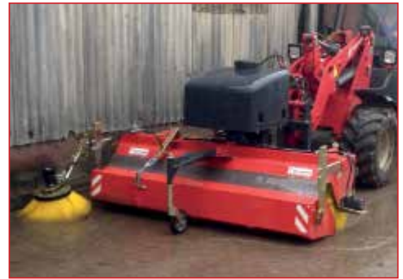
KM 570 HL mit Wassersprüheinrichtung und Seitenbesen am Weidemann
