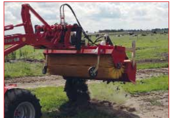
KM 570 HL mit hydraulischer Wannentleerung
