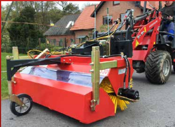
Die KM 570 HS angebaut am Weidemann-Hoflader im Frontanbau mit zusätzlichem 3. Stützrad vorn.
