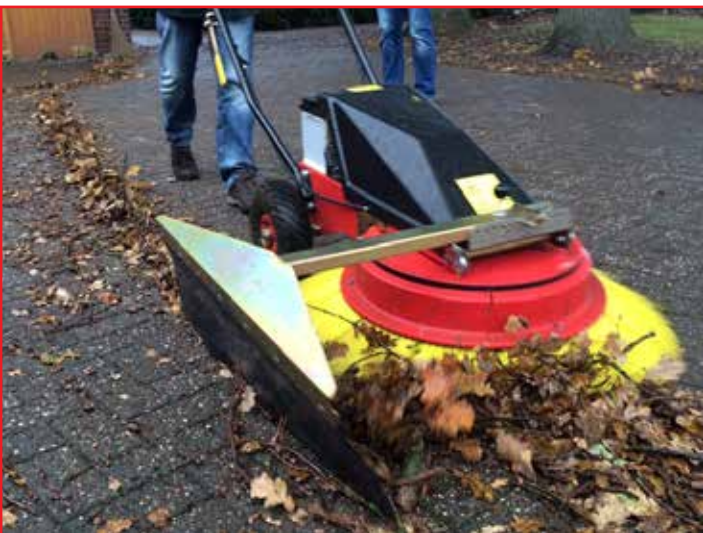
Sechs einzelne Besensegmente ergeben den Ringbesen.
