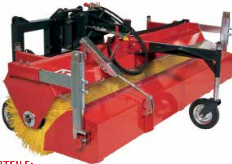
KM 570 HL mit Wassersprüheinrichtung und Seitenbesen am Weidemann
