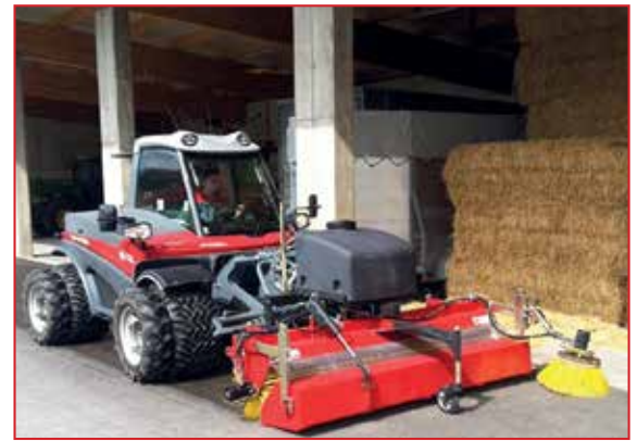
KM 570 UH mit Wassersprühleinrichtung, Seitenbesen und hydr. Entleerung.
