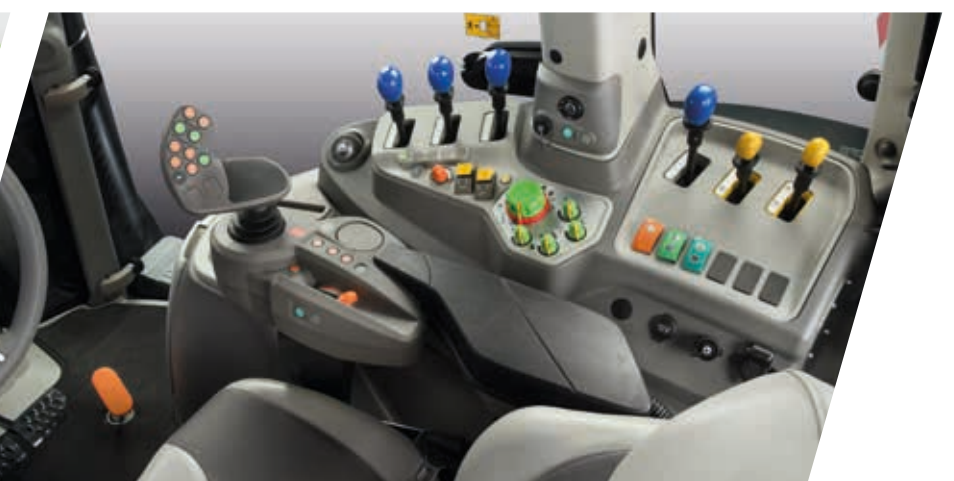
> L'équipement de la cabine MaxiVision à distributeurs arrière entièrement mécaniques est disponible pour les modèles Powershift (grande photo) et RCshift (photo ci-dessus).
