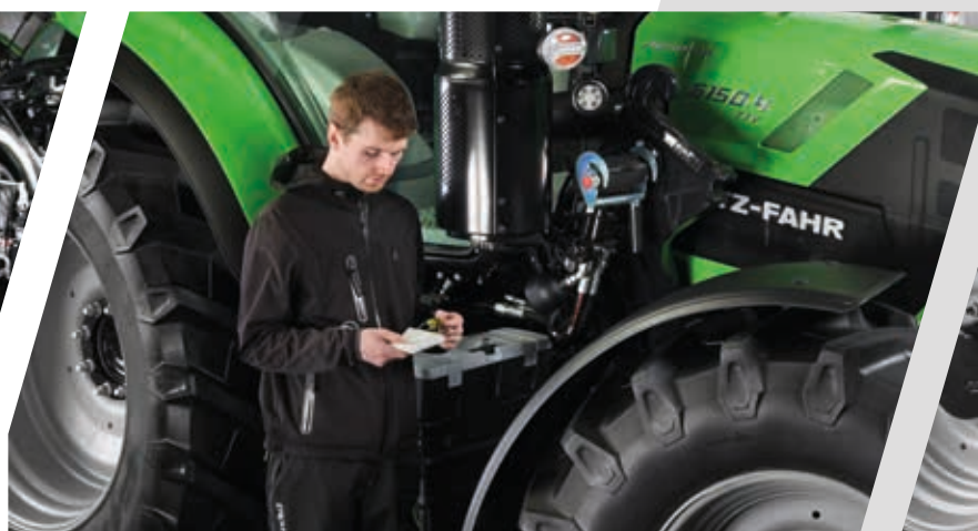
> La jauge d'huile moteur est accessible sans ouvrir le capot.
