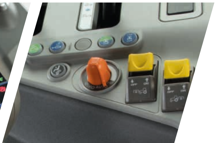
> Facile et intuitif – avec le bouton de réglage ECO/Power, l'opérateur peut modifier le comportement de changement de vitesse de l'APS (Automatic Powershift).
