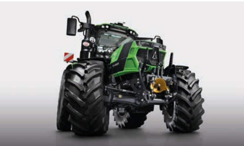
> Pont avant suspendu avec blocage intégral du différentiel avant.
