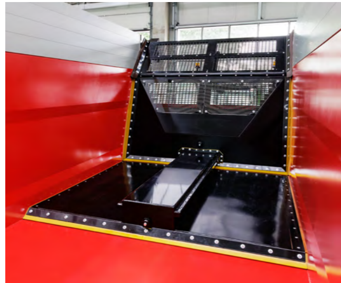
Beim Abschiebevorgang des RamBody 680 bewegen sich drei Hydraulikzylinder den Schild gleichmäßig zum Fahrzeugheck. Somit werden nur 21 Liter Öl für den Abladevorgang benötigt.
