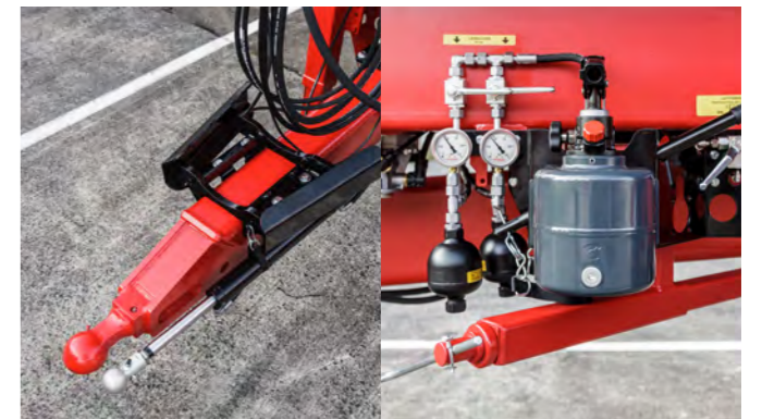
BPW Zwangslenkung: dw-Geberzylinder befindet sich vorne an der Zugvorrichtung, Fahrrichtung links & rechts beim Tridem, hydr. Anlage komplett mit Handpumpe, Manometern und Stickstoffspeichern.
