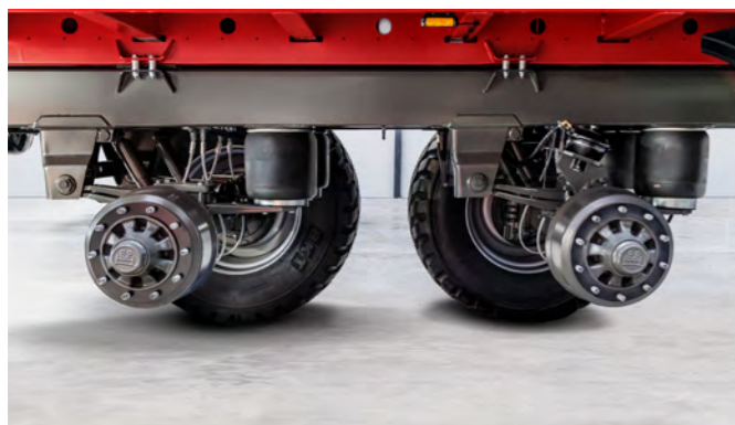
Luftgefederte Fahrwerke sind im Trend und werden auf Wunsch verbaut. Die großen Luftfederbälge sorgen für Laufruhe und ein stabiles Fahrverhalten.
