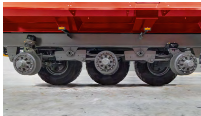
Beim RamBody 900 verwenden wir 36 t Parabelfedern mit Längslenkern und dynamischem Achsausgleich mit Achsabstand von 1,55 m.
