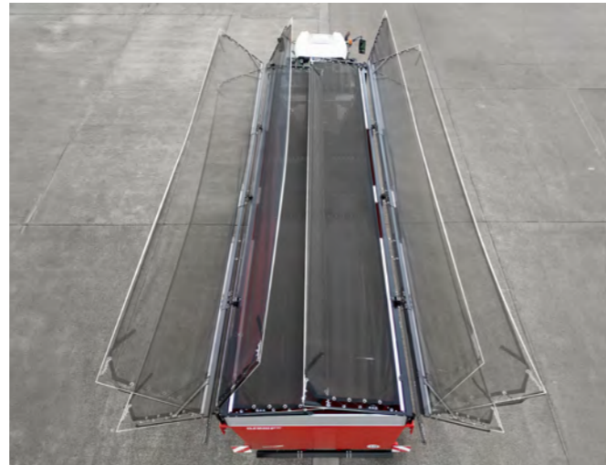
Das zweiseitige, hydraulische Krampe TwinTop Verdeck öffnet und schließt sich in nur ca. 15 Sekunden und lässt sich bequem von der Fahrerkabine aus steuern. Mit einer Aufbauhöhe von ca. 8 cm sucht das TwinTop im Markt seinesgleichen.
