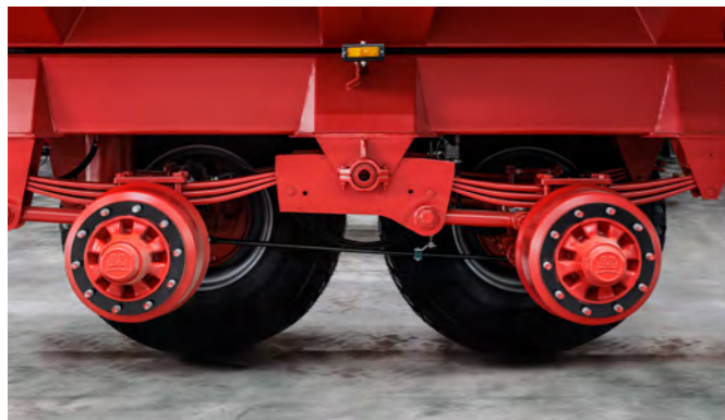
Die standardmäßig verbauten Parabelfedern garantieren große Bodenfreiheit. Lieferbar mit einem Achsabstand von 1,55 und 1,81 m, 24 t und 32 t beim Tandem.
