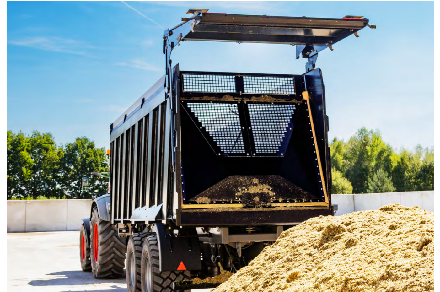
Unser RamBody 750 entlädt 40 m 3 Silomais in nur ca. 45 Sekunden bei einem Ölstrom von 100 l/Minute.
