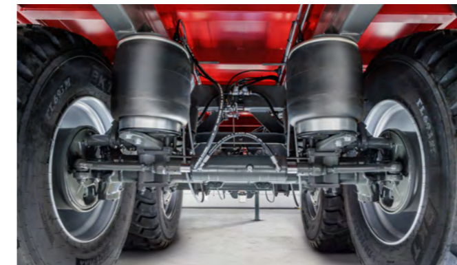
BPW Nachlaufenkung: Ausführung mit Wellendruckscheibe für ein ruhiges Fahrverhalten. Die Lenkachse muss bei Straßenfahrten hydraulisch gesperrt werden.
