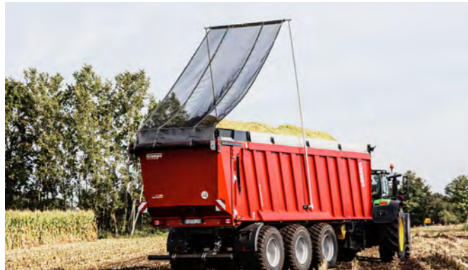
Die seitlich schwenkbaren Alu-Bügel öffnen und schließen das Netzcover.
