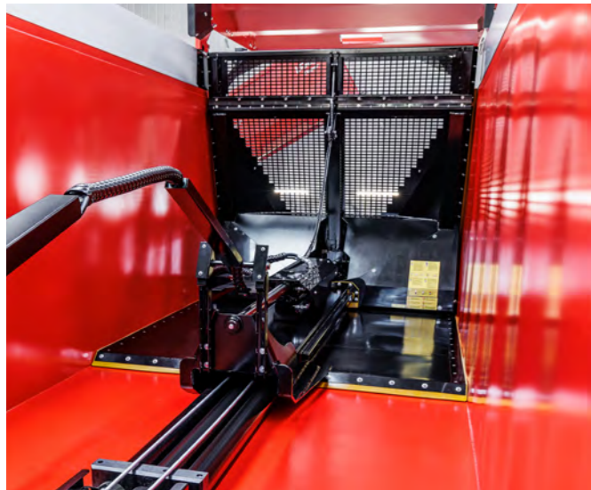
Beim Abschiebevorgang des RamBody 750 und 900 bewegen fünf Hydraulikzylinder den Schild gleichmäßig zum Fahrzeugheck. Das Schiebeschild ist im Ruhezustand in der Fahrzeugfront zusammengeklappt, somit verliert die Wanne kaum an Volumen.
