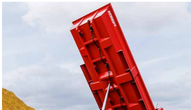
Schwere Wannenunterzüge und ein Unterflurzylinder zeichnen die HD Wanne aus.
