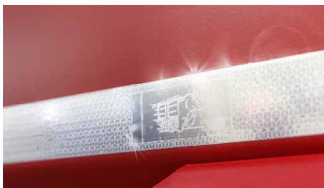
Um die Sichtbarkeit der Fahrzeuge zu erhöhen, kann Reflektorband in Weiß und Gelb an den Fahrzeugseiten und in Rot im Fahrzeugheck aufgeklebt werden.
