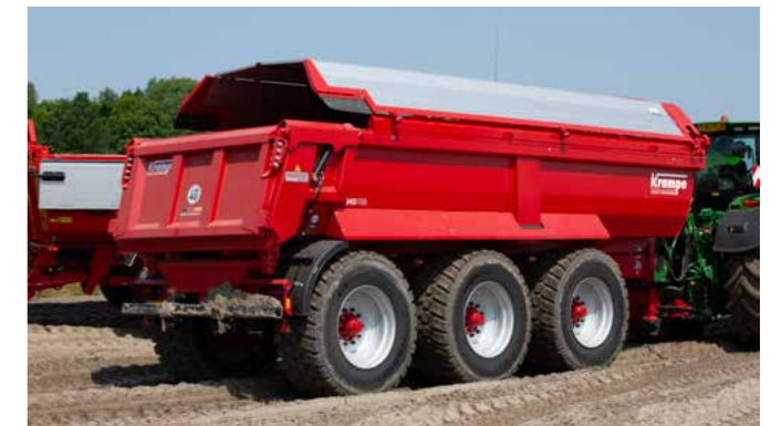
Das hochwertige Aluminium-Klappverdeck lässt sich in nur ca. 20 Sekunden öffnen und schließen und ist bis 9,0 m Länge verfügbar.
