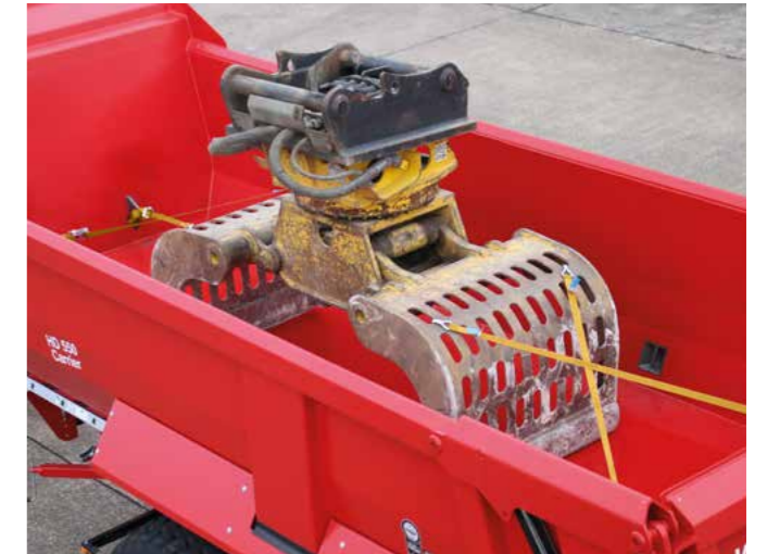
Zur Ladungssicherung sind optional Zurrpunkte in den Heavy Duty Wannern verfügbar.
