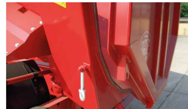
Bei Ladung mit hohem Feuchtigkeitsgehalt sorgt die wasserdichte Heckklappe für einen sicheren Transport.
