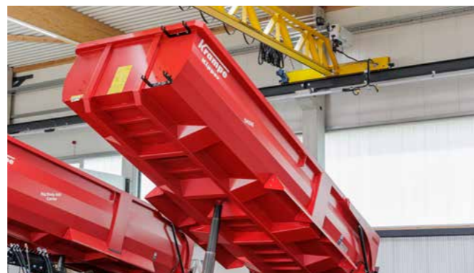
Die SK Wanne zeichnet sich durch schwere Wannenunterzüge und einen schweren Unterflurzylinder aus.
