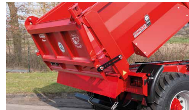
Die Sörling-Heckklappe ist nur 30 cm hoch und hat auf ganzer Breite eine untenliegende Schanierwelle.
