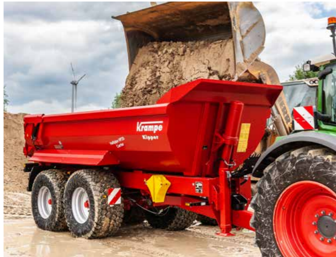
Die Stirnwanthaube schützt die Frontalpresse und Zugvorrichtung vor Beschädigungen durch herabfallende Ladung.
