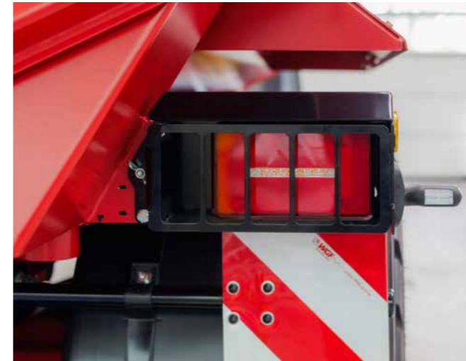
Unsere Schutzgitter verhindern Beschädigungen ohne die einzelnen Elemente der Rückleuchten zu verdecken.
