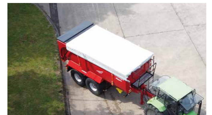
Die Wickelplane kann direkt auf der Grundwanne befestigt werden. Auch auf Silageaufsätzen ist der Einsatz von einer Wickelplane problemlos möglich, lieferbar für SK-Modelle.
