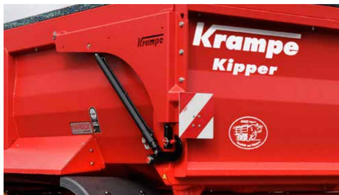
Hydraulisch öffnende Heckklappe mit automatischer seitlicher Anpressung, Sperrblockventil, Sicherheitskugelhahn, und Schließhaken-Stopp-Modus, der die Schließhaken bei Bedarf außer Kraft setzen kann.
