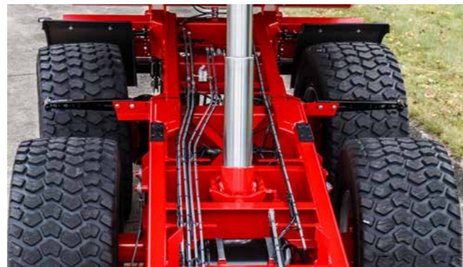
Durch das gekrüpftes Fahwerk mit Spurweite 1,95 m ist bei einer 600er Bereifung eine Aussenbreite von 2,55 m möglich.
