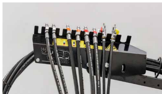
Der Schlauchhalter schafft Ordnung und ist durch wenige Handgriffe in Länge und Höhe verstellbar.
