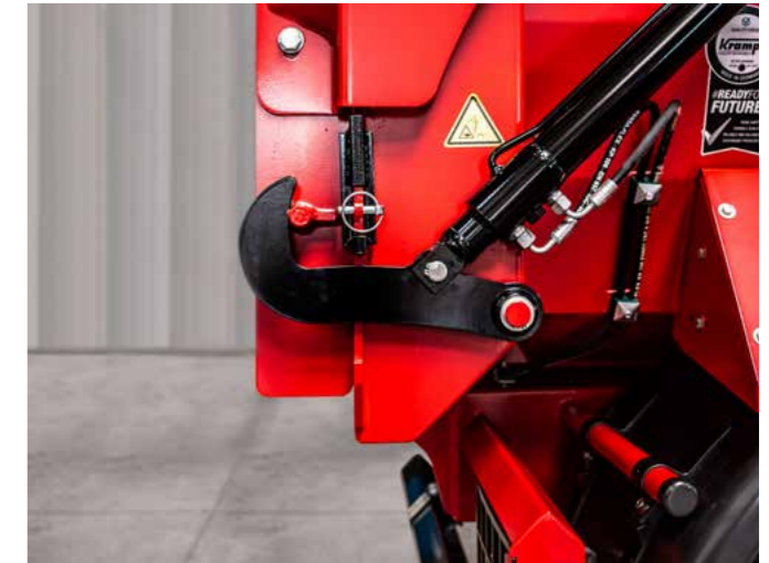
Die hydraulisch öffnende Heckklappe der SK Baureihe wird über die seitlichen Schließhaken automatisch angepresst und konstant auf Druck geschlossen gehalten.
