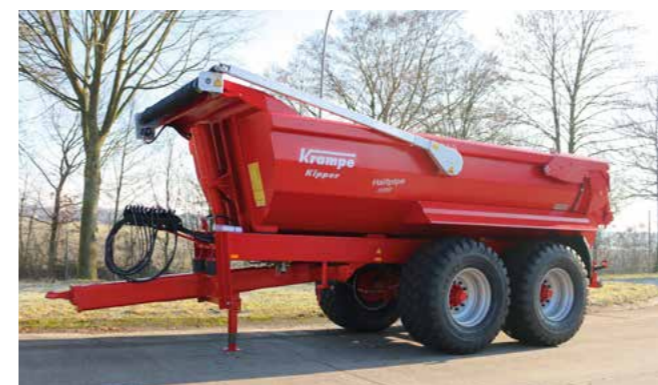
Das Verdeck mit Netzabdeckung ist die einfache und schnelle Art der Ladungssicherung, lieferbar für SK, HD und HP Modelle.
