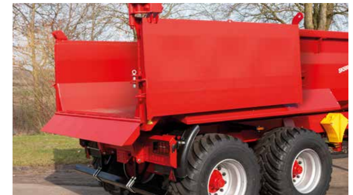
Die Pendel-Schwenklappe dient als Ergänzung zur Sörling-Heckklappe. Sie wird oberhalb pendelnt gelagert und ist zusätzlich in Fahrtrichtung nach rechts aufschwenkbar.
