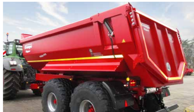
Die Wannenhöhe kann bei HP 20 und HP 30 auf 1,40 Meter erhöht werden.
