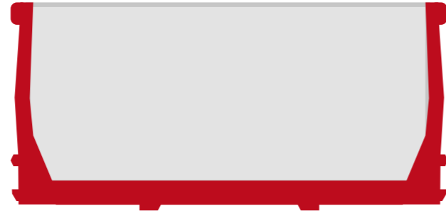
Konische Wanne mit flachem Bodenblech. Durch optionale Aufsatzbordwände kann das Volumen für den Leichtgut Transport erhöht werden.
