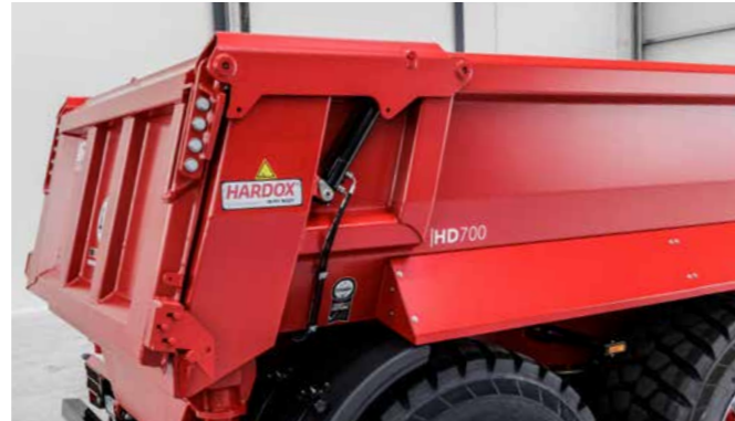
Die robuste hydraulische Heckklappe mit geschützten Hydraulikzylindern ist zusätzlich pendelnd gelagert.
