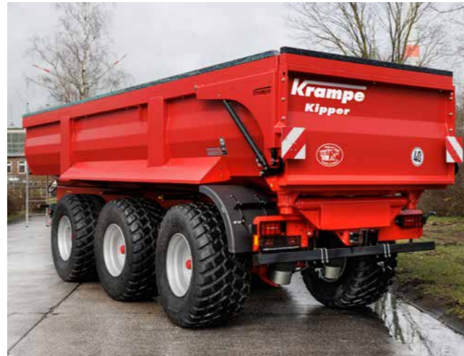
Eine ringsum auf der Rahmenkrone montierte Scheuerleiste aus Kunststoff mit eingeschweißten Hülsen in der Rahmenkrone ist optional verfügbar.
