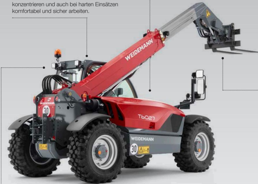
**Hervorragende Rundumsicht.** Der T6027 bietet besonders gute Sicht nach rechts dank tiefgezogener, abfallender Motorhaube. Die Seitenscheibe der Kabine sowie die Scheibe hinten sind optional beheizbar. Dies verbessert die Sicht im Winter erheblich. Dort wo Durchfahrten von unter 2 m nicht benötigt werden, bekommt der Fahrer durch eine Kabinenerhöhung von 12 cm einen noch besseren Überblick über den gesamten Arbeitsbereich.
