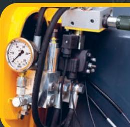
Des électrovannes HAWE avec un filtre à haut pression dans le bloc de direction prévenant une perte de pression.
