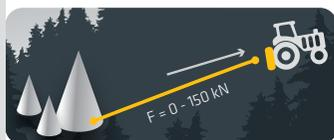
La force de freinage réglable permet le déroulement du câble d'acier sans appareil de déroulement, avec une force du câble d'acier aléatoire entre le treuil et la charge.
