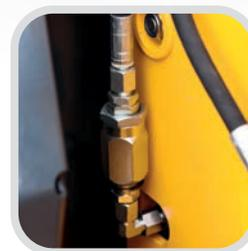
Le régulateur de vitesse d'ouverture du frein permet un relâchement plus lent de la tension du câble d'acier. Empêchant ainsi une rotation incontrôlée du tambour et par conséquent une torsion du câble d'acier.
