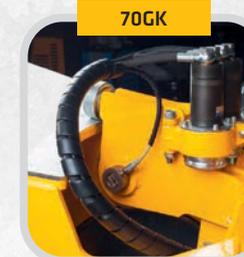
Le détecteur de mesure de la force de traction du treuil est placé directement sur le câble de traction et mesure ainsi précisément la force du câble de traction. La force mesurée du câble d'acier se régule avec l'embrayage. Un guide pour un enroulement précis du câble d'acier sur le tambour est intégré de série.
