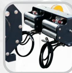
L'appareil de déroulement avec deux cylindres de pression et deux moteurs hydrauliques permet, durant le processus de déroulement, une plus grande tension du câble d'acier entre l'appareil de déroulement et le tambour et assure une plus grande force de déroulement. Possibilité de régler la vitesse de déroulement du câble d'acier.
