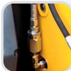
Le régulateur de vitesse d'ouverture du frein permet un relâchement plus lent de la tension du câble d'acier. Empêchant ainsi une rotation incontrôlée du tambour et par conséquent une torsion du câble d'acier. Existe sur tous les modèles sauf 120G power.
