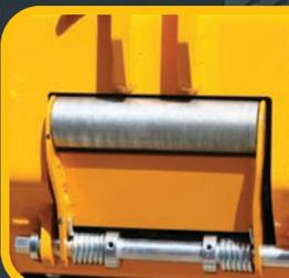
Un cylindre de pression pour un enroulement précis du câble d'acier sur le tambour.
