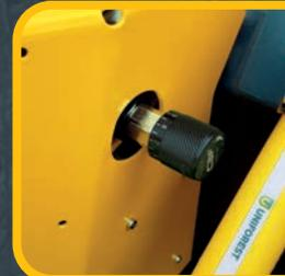
Une valve pour le réglage de la vitesse assure une tension constante du câble d'acier. Un filtre à huile à haute pression empêchant les impuretés de pénétrer dans le bloc hydraulique.
