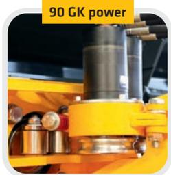
L'appareil de déroulement avec deux cylindres de pression et deux moteurs hydrauliques permet, durant le processus de déroulement, une plus grande tension du câble d'acier entre l'appareil de déroulement et le tambour et assure une plus grande force de déroulement.
