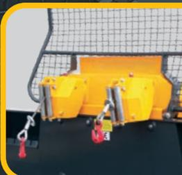
Le dispositif de déroulement du câble d'acier avec la possibilité de régler la vitesse de déroulement du câble. Une poulie en roue libre articulée pour un positionnement optimal par rapport au sens de traction.
