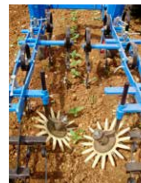
Gerade Montage für Reihenabstände von 0,60 bis 1 m
