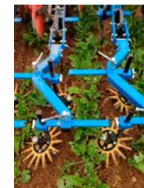
S-Montage für Reihenabstände von 0,45 bis 0,60 m
