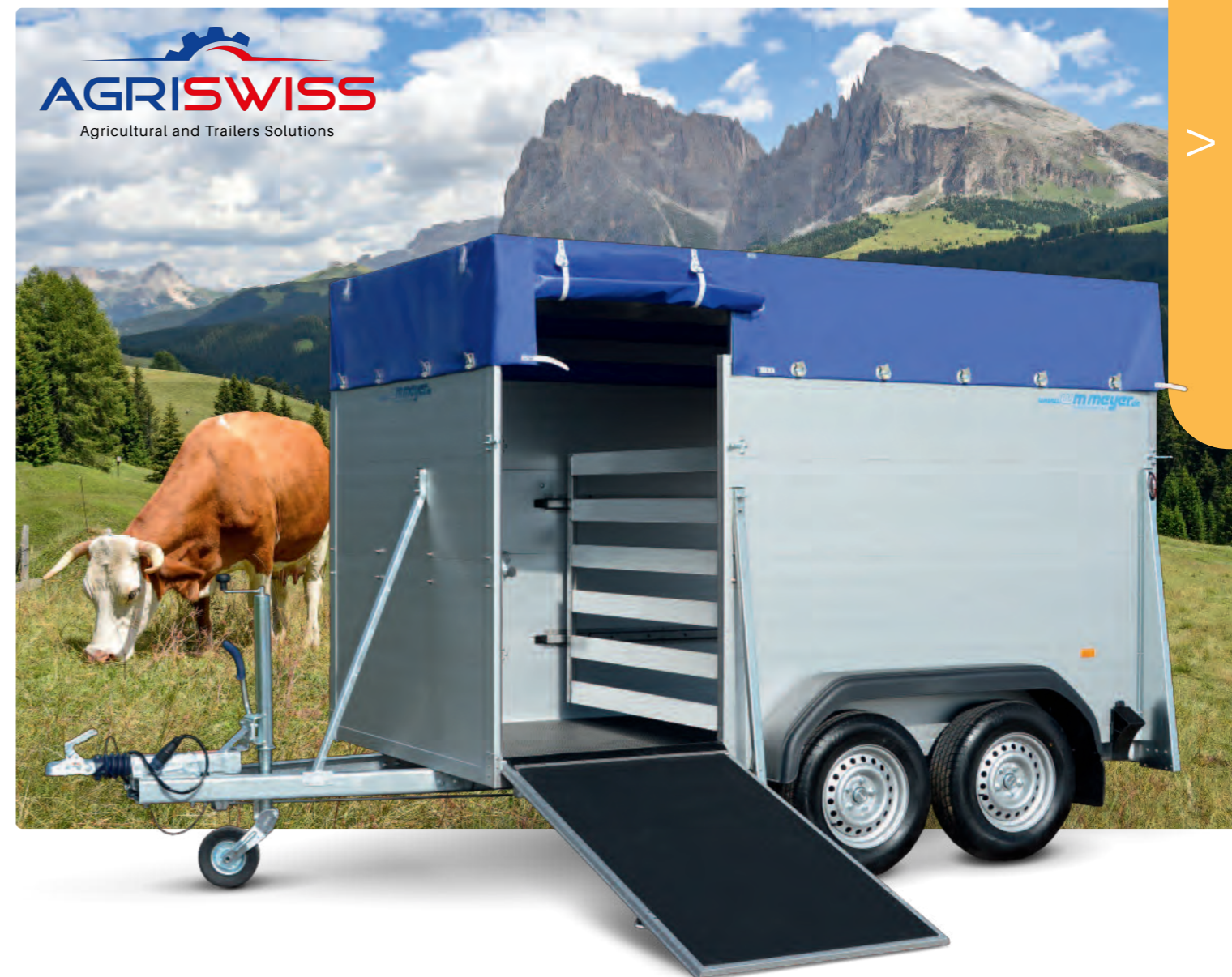
V 2730/164 Vollaluminiumanhänger, Zubehör: Gummiboden, Frontausstieg, Trenngitter, Hochplane und Aluspiegel V 2730/164 Bétaillère complètement en alu, options : protection plancher, pont avant, séparation à l'intérieur, bache haute et ossature en alu V 2730/164 All-aluminium trailer, optional extras: rubber floor covering, front exit, cross division, high canvas top and aluminium support
