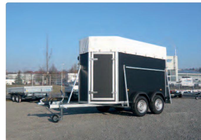
V 2730/149 Zubehör: Einzelradkotflügel, Hochplane und Aluspiegel V 2730/149 Options : garde-boues individuels, bache haute, ossature en alu V 2730/149 Extras: indiv. mudguards, high canvas top, aluminium support
