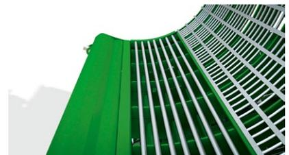
Das neue Dreschkorbsegment wird eingesteckt und durch Anziehen der Kontermuttern fixiert.
