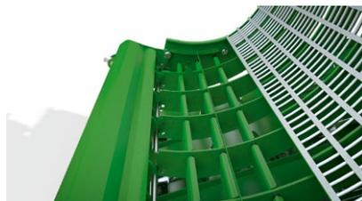
Zum Entfernen müssen lediglich die Verriegelungsbolzen gelöst werden.
