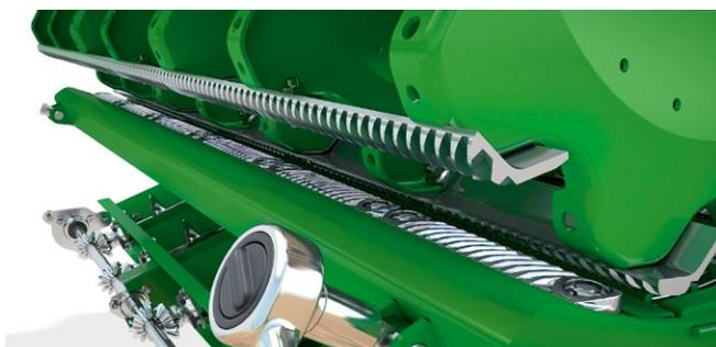
Zum vollständigen Einschwenken der Intensivreibleiste genügen wenige Umdrehungen mit einem Steckschlüssel.
