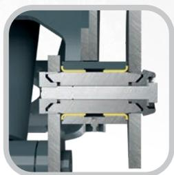
L'axe est stabilisé à l'aide de douilles coniques qui empêchent d'avoir un jeu entre l'axe et le boîtier. Toutes les pièces mobiles ont des roulements coulissants intégrés avec un système de graissage intégré.
