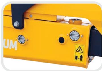
Le système coulissant réglable sur le bras télescopique aide à éliminer le jeu entre la plaque coulissante et le métal. Grâce à un matériau spécial, la plaque coulissante n'exige pas de graissage.
