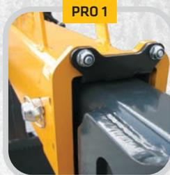
La longueur du bras du télescope est fixée avec un boulon.
