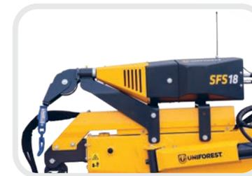
Il est possible d'installer un treuil hydraulique avec une radiocommande pour tracter les grumes et faciliter la manipulation des grumes.
