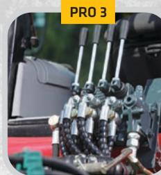
Direction à l'aide de manettes de direction. La valve flottante (rotateur) est relâchée en position neutre pour une adaptation automatique au terrain.
