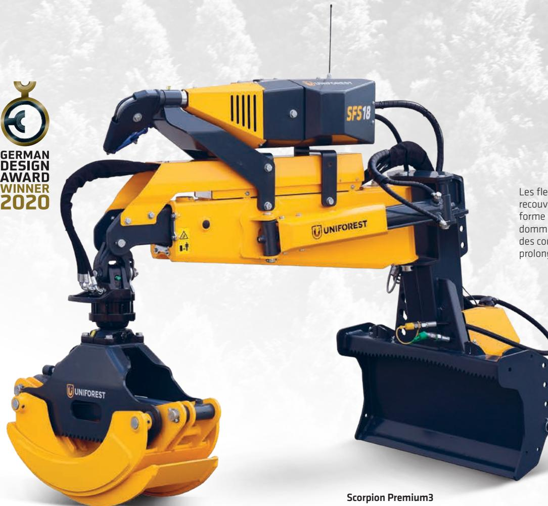
Les flexibles et vérins hydrauliques sont recouverts d'un châssis robuste mais de forme dynamique pour se protéger des dommages mécaniques. Cela garantit des coûts de maintenance minimes et prolonge la durée de vie de la machine.
