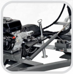
Vérin hydraulique intégré pour déploiement en position travail ou transport.
