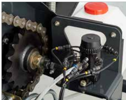
7. Automatische kontinuierliche (BEKA-MAX) Kettenschmierung
