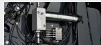
Automatische Zentralschmierung mit 400 g Fettkartusche (BEKA-Max)
