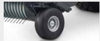
Nachlaufende Pick-up Tasträder mit Nonstop-Luftkammer-Reifen
