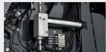
Automatische Zentralschmierung mit 400 g Fettkartusche (BEKA-Max)
