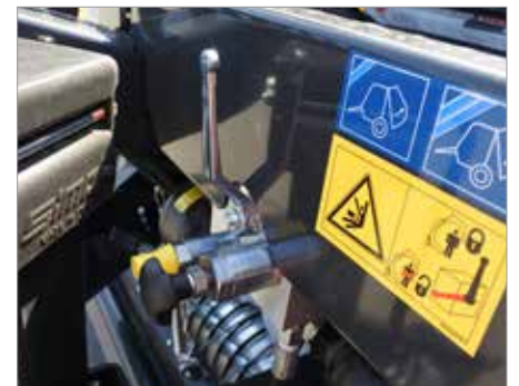
5. Pressdichteregelung POWER LOCK
