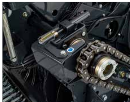
4. Hydraulische Rotorentkopplung aus der Kabine
