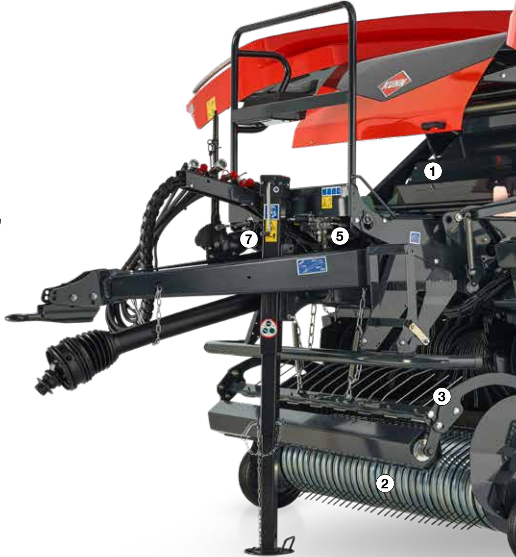
1. Robuster Antrieb mit hochwertigen IWIS-Ketten
