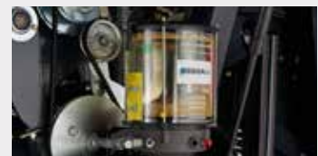
Automatische Zentralschmierung mit 4 kg Vorrat (BEKA-Max)
