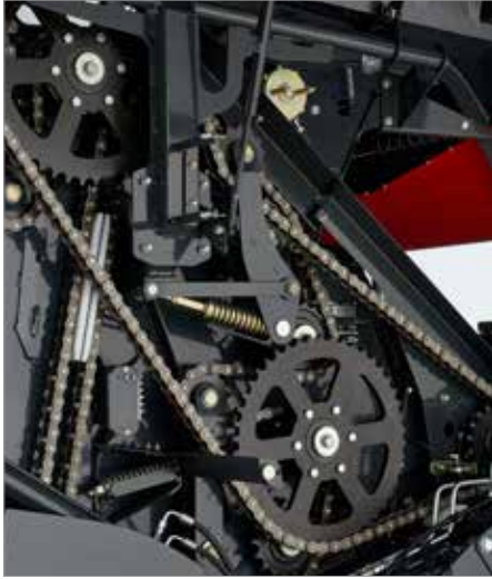
1. Robuster Antrieb mit hochwertigen IWIS-Ketten
