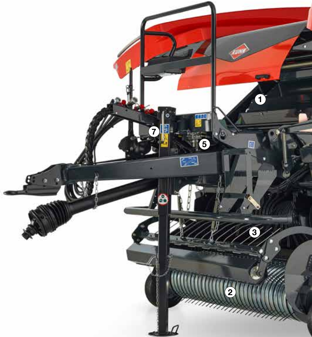
1. Robuster Antrieb mit hochwertigen IWIS-Ketten
