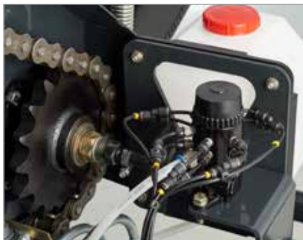
7. Automatische kontinuierliche (BEKA-MAX) Kettenschmierung
