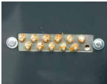
6. Zentral angeordnete Schmierbänke für die Walzenlager
