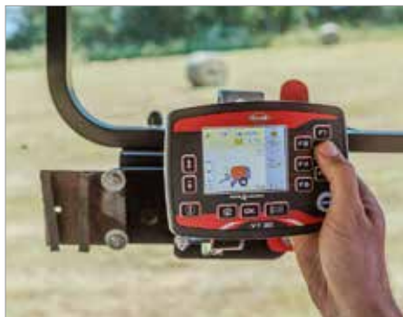
6. Vorauswahl für die Steuerung von Pick-up/ DROPFLOOR (absenkbarer Förderkanalboden)/ Messern am Terminal
