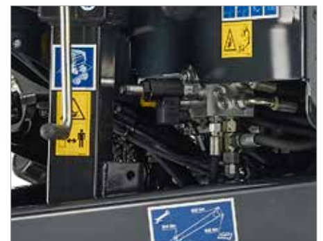
5. Pressdichteregelung POWER LOCK
