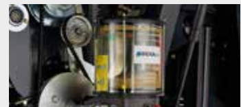
Automatische Zentralschmierung mit 4 kg Vorrat (BEKA-Max)
