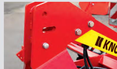
Verschiedene Positionen für Oberlenker, inklusive Schwimmstellung
