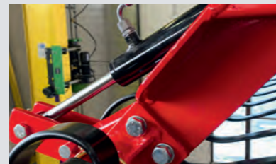
Vorwerkzeug hydraulisch wegklappbar
