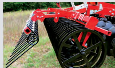
Striegel mit Höhenverstellung und Winkelverstellung
