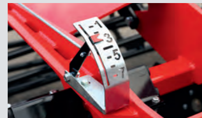
Gut sichtbare Skala der Tiefeneinstellung
