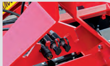
Schlauchgarderobe für Ordnung während der Lagerung
