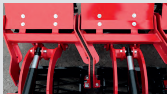
Z-förmig versetzte Reihen vermeiden Lücken zwischen den Walzenabschnitten
