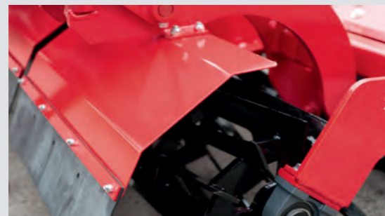
Schutzbleche schützen den Schlepper vor Steinschlagschäden
