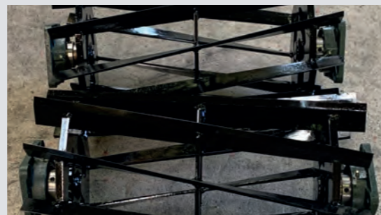
Gegenläufig gestellte Messer sorgen für Kreuzschnitt
