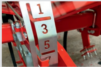
Gut sichtbare Skala zur Tiefeneinstellung
