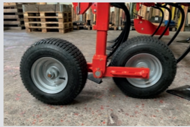
Tandemstützräder zur exakten Tiefenführung bei ultraflacher Bearbeitung mit Skala
