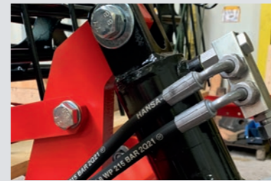
Hydraulische Arbeitsstiefeneinstellung mit Sperrblock
