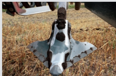
Boehlerit Schare für extram lange Standzeit
