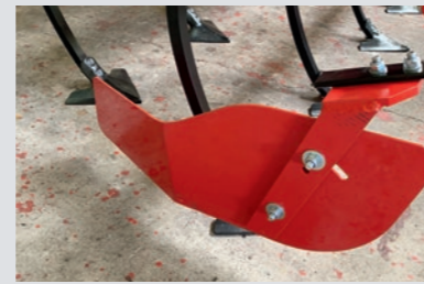
Großes Randblech zur exakten Anschlussfahrt
