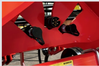
Schlauchgarderobe für witterungsgeschützte Lagerung
