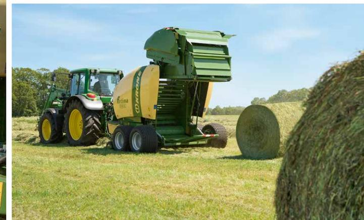
Die KRONE Fortima ist für jeden Einsatzzweck gewappnet. Die Rundballenpresse besteht durch ihren einfachen Aufbau, sowie einer intuitiven Bedienung. Dank Stabkettenelevator können alle Erntematerialien problemlos gepresst werden. Egal ob Heu, Stroh oder Silage!
